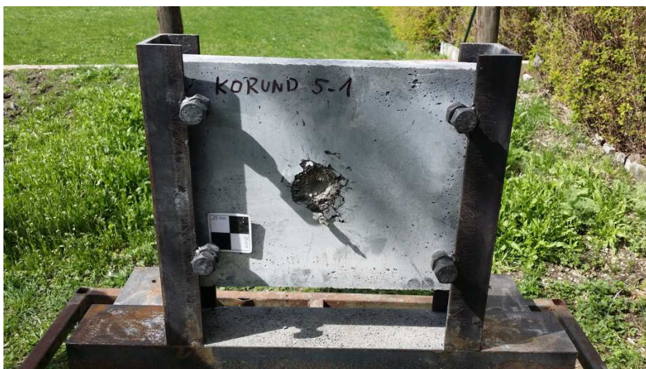
[obr. 4.10] Vzorek UHPSFRC s obsahem 5% korundu zasažen jednou ranou projektilu 7,62×39 vz 43
