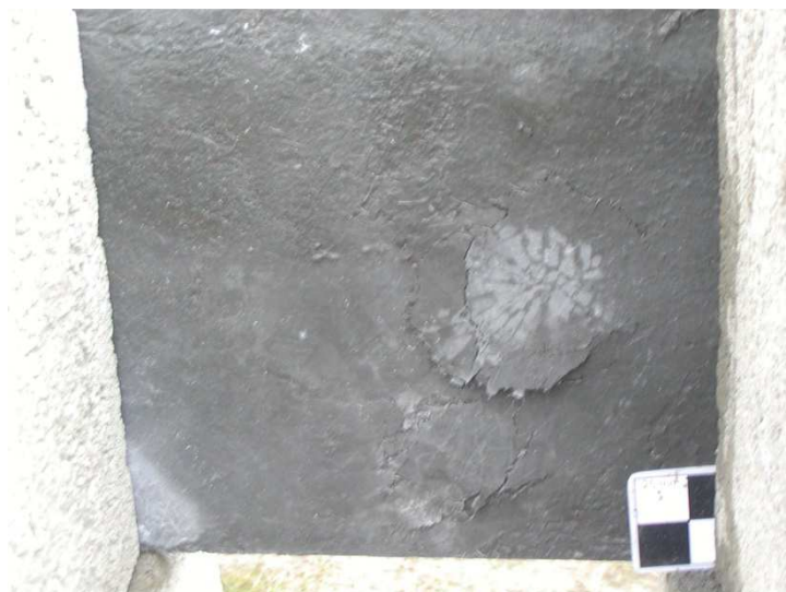
[obr. 5.19] Zadní strana desky z UHPSFRC s železitým kamenivem po zásahu tří projektilů
