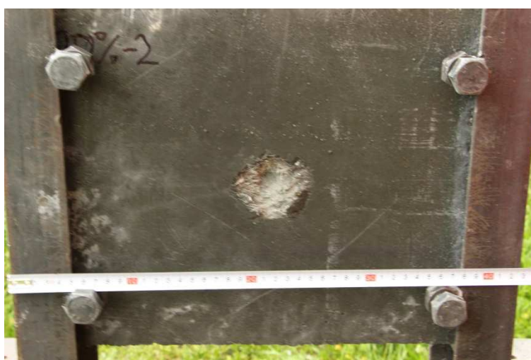
[obr. 5.16] Vzorek Korund30_2 po zásahu projektilu
