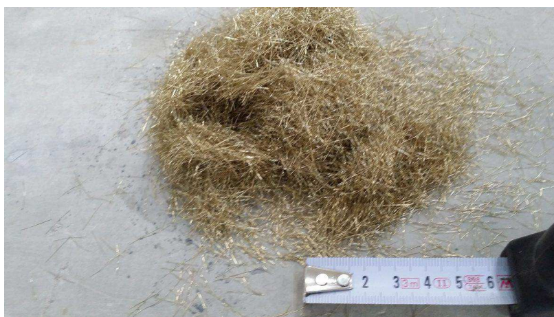
[obr. 4.1] Ocelová vlákna o délce 13 mm a průměru 0,15 mm
