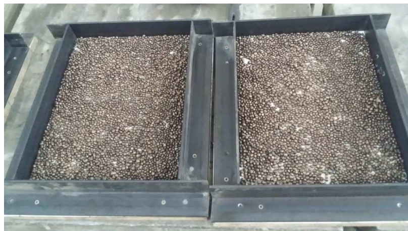
[obr. 4.6] Výroba vzorků UHPSFRC s obsahem železitého kameniva
