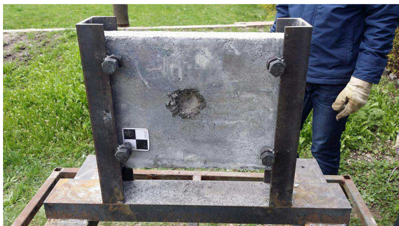
[obr. 5.17] Vzorek Čedič30_1 po zásahu projektilu
