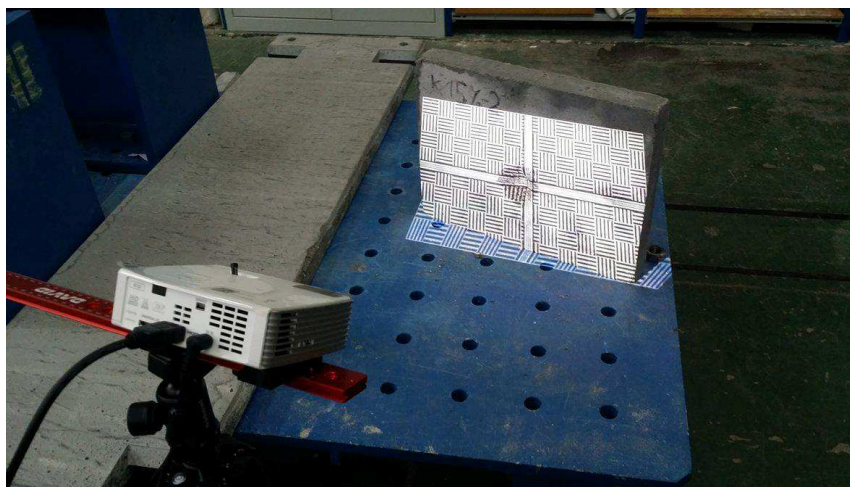
[obr. 5.1] Snímání kráteru na přední straně desky pomocí skeneru David 3D
