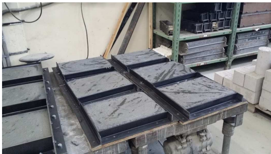
[obr. 4.4] Vzorky v bednění 400 \times 300 \times 50 \text{ mm}^3
