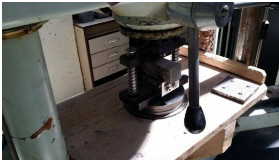
[obr. 4.7] Tříbodová zkouška pevnosti v tahu za ohybu
