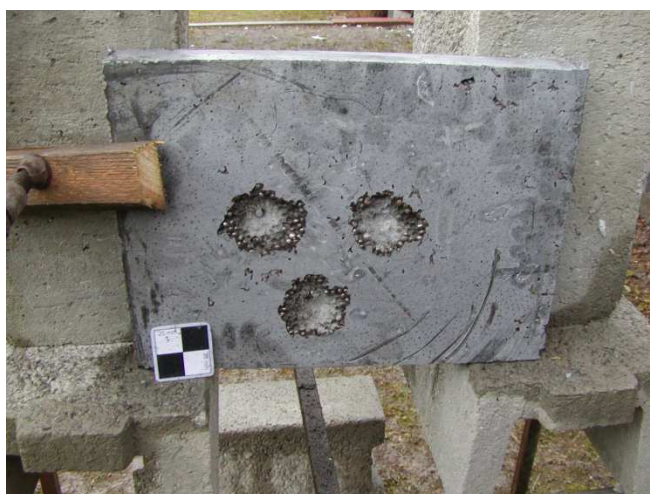
[obr. 5.18] Přední strana desky z UHPSFRC s železitým kamenivem po zásahu tří projektilů
