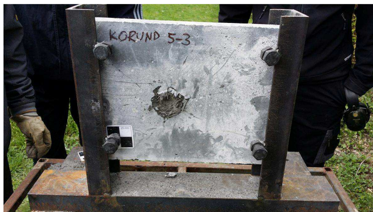
[obr. 5.14] Vzorek Korund5_3 po zásahu projektilu
