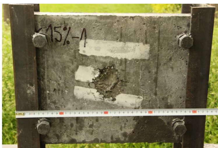
[obr. 5.15] Vzorek Korund15_1 po zásahu projektilu
