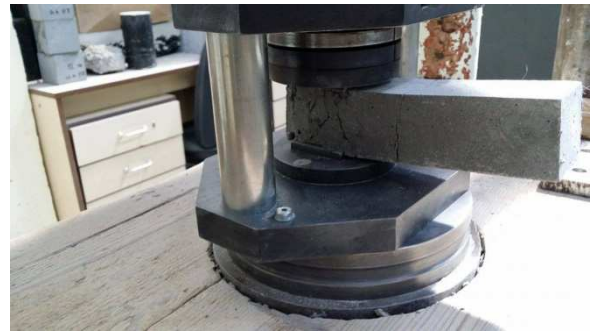
[obr. 4.8] Měření pevnosti v tlaku
