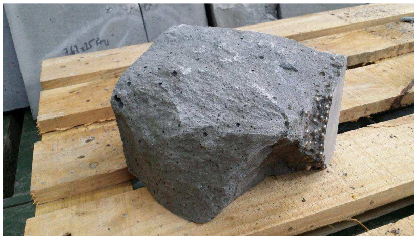
[obr. 4.5] Rozbitá krychle UHPC s obsahem železitého kameniva
