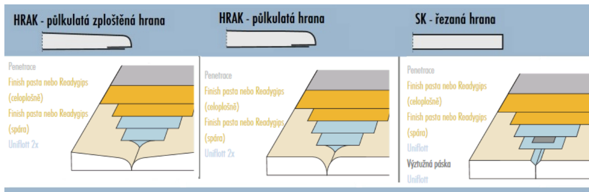
Obr. 5: Spárování pro systém Uniflott pro stupeň kvality Q3
