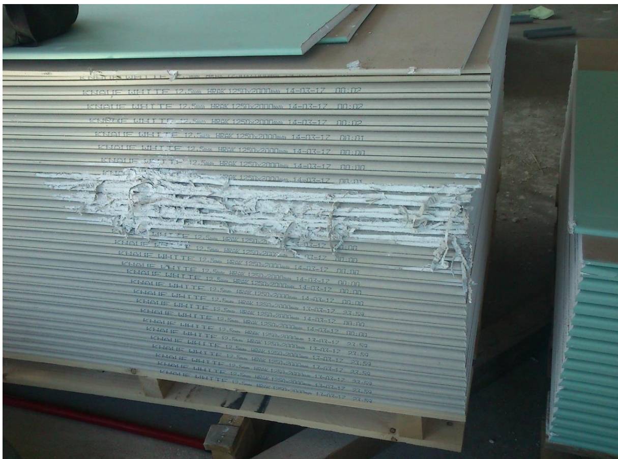
Obr. 31: Desky poškozené během přemístování na pracovní místo
