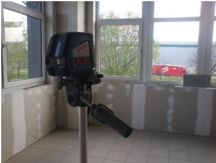
Obr. 41: Stavební laser používaný pro kontrolu rovinnosti profilů
