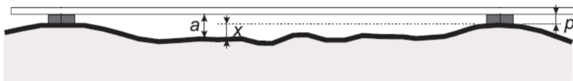
Obr. 9: Znárodnění kladení latě s podložkami na povrch
