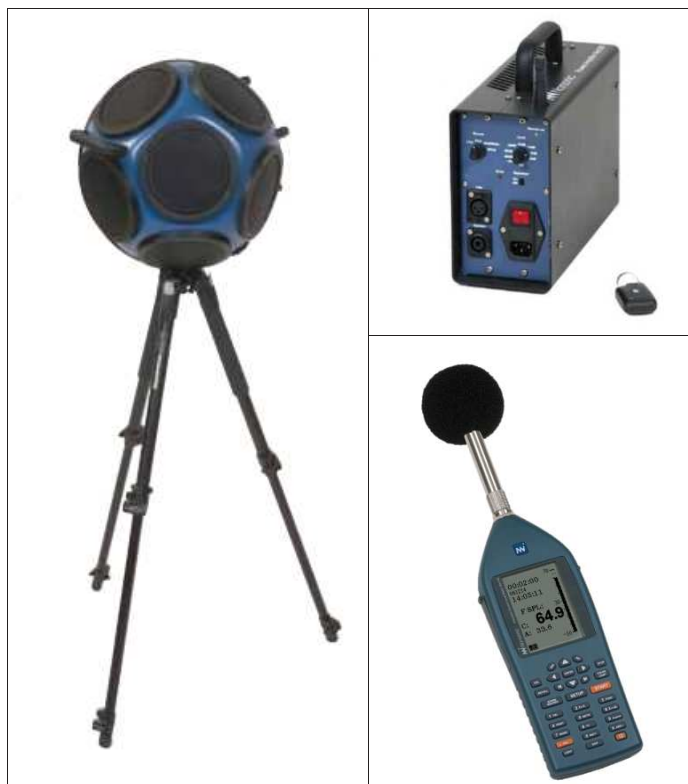
Obr. 1 - Vybavení pro měření doby dozvuku (všesměrový reproduktor, výkonový zesilovač, zvukoměr s mikrofónem) [13]
