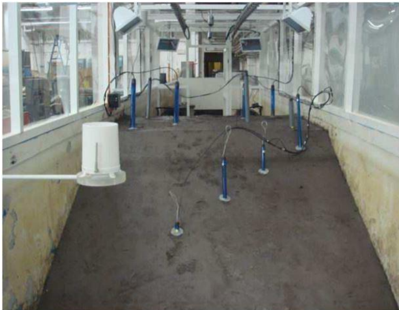
Obrázek 8: Model hráze s měřicími přístroji [13]
