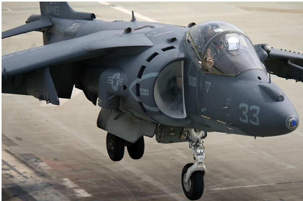
Obr. 35 Přísávací klapky vstupního ústrojí motoru letounu Harrier [13]
