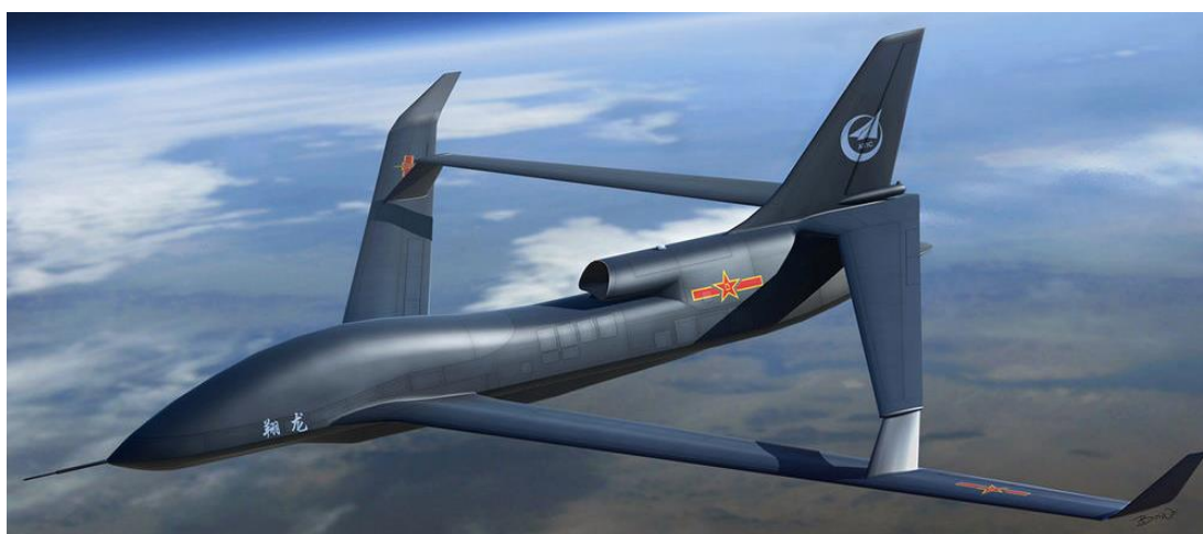
Obr. 1 Čínský Xiang Long, neboli Guizhou Soar Dragon, HALE UAV s velmi netypickým uspořádáním hlavních nosných ploch, jež je tvořeno dvěma navzájem propojenými tandemově uspořádanými křídly s rozdílným rozpětím [28]
