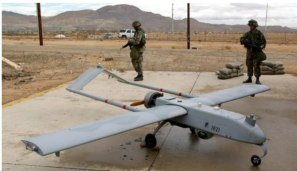
Obr. 3 AAI RQ – 7 Shadow, jako představitel TUAV. Vzhledem k menším rozměrům oproti většině letounů z kategorií HALE a MALE jsou tyto prostředky výrazně mobilnější. [23]
