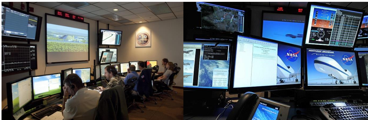
Obr. 38 Řídící stanice prostředku Global Hawk v Armstrongovu (dříve Drydenovu) leteckém výzkumném středisku NASA. Vlevo stanoviště operátorů přímo se podílejících na letu, vpravo detail stanoviště pilota. [35] [21]
