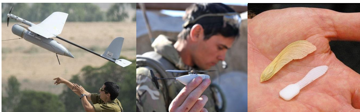
Obr. 5 Příklady kategorií Mini UAV, Micro UAV a Nano air vehicles (v pořadí zleva doprava) [22] [30] [59]
