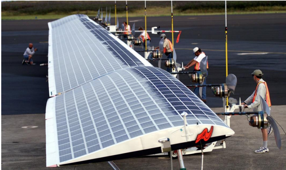
Obr. 16 Helios Prototype se svými elektromotory a fotovoltaickými články instalovanými na celé ploše křídla [36]
