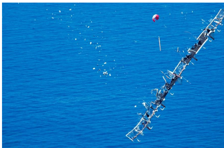
Obr. 26 Již značně poškozený Helios Prototype těsně před nárazem do vodní hladiny [40]
