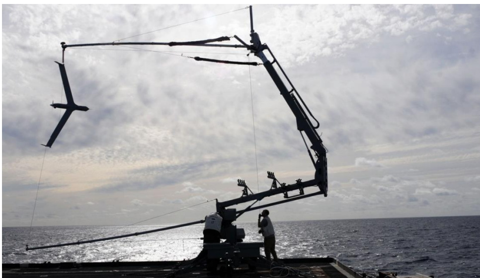
Obr. 4 Boeing Insitu ScanEagle svými výkony zastiňuje většinu dalších Close-range UAV, přesto svým určením, využitím a rozměry nezapře své začlenění. Na fotografii je zachycen jeden ze způsobů jeho zachycení, které je pro tyto a TUAV prostředky často velmi specifické a náročné. ScanEagle využívá i Armáda České republiky. [19]
