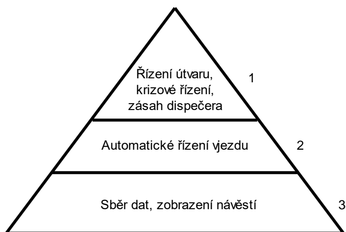
Obr. 2: Funkční architektura RMC
