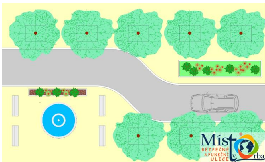
Obr. 39 Schéma šikany – boční odstup (zdroj. http://mistotvorba.cz )
