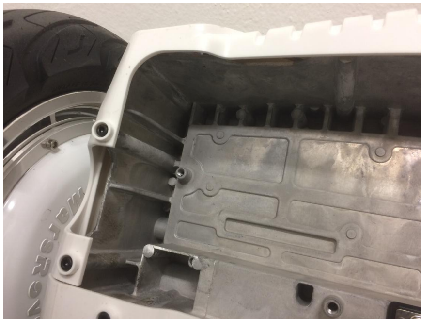
Obrázek 22 - Fotografie hliníkové konstrukce přístroje
