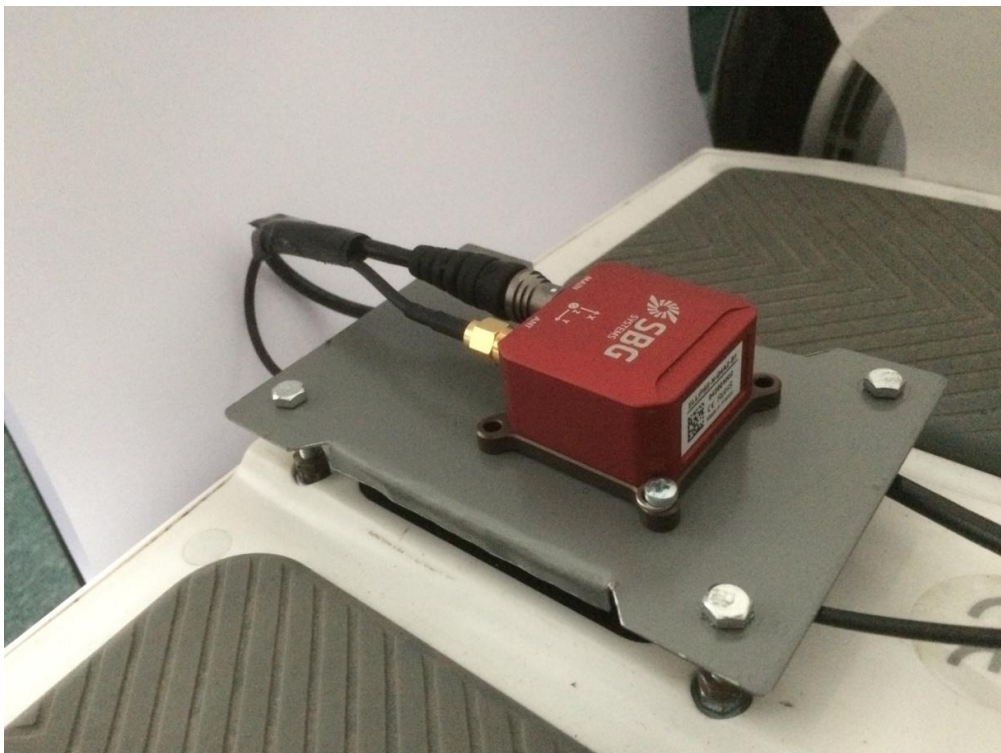
Obrázek 24 - Detail uchycení akcelerometru
