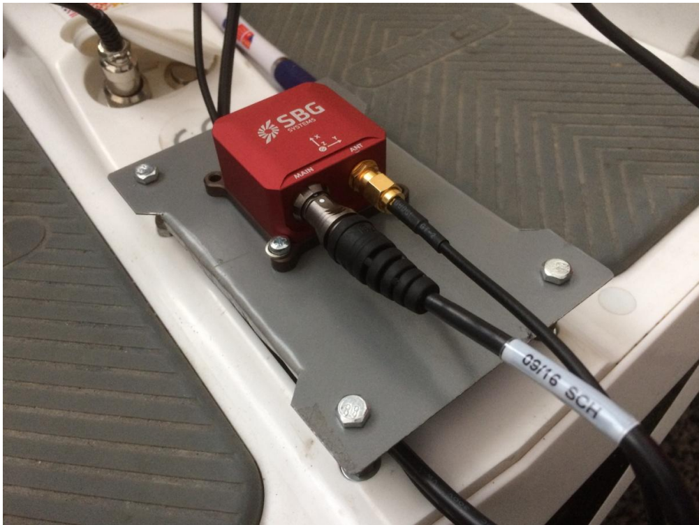
Obrázek 23 - Detail uchycení akcelerometru
