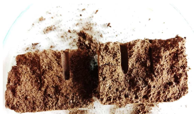
Obrázek 3.8: Fotografie řezu půdního vzorku po vyjmutí tenzometru T5 a prototypu mikrotenzometru.
