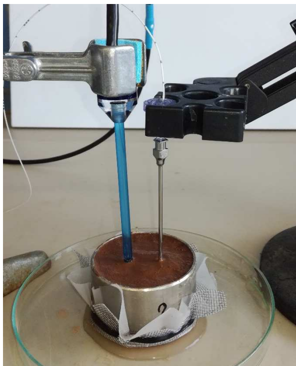
Obrázek 3.7: Fotografie experimentálního set-upu při zjišťování rozsahu měření mikrotenzometru v půdním vzorku; vlevo (modrý) tenzometr T5, vpravo (stříbrný) prototyp mikrotenzometru.
