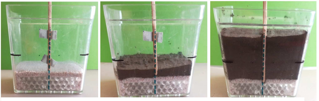
Obrázek 3.10: Postupná příprava vzorku s uměle vytvořeným makropórem.
