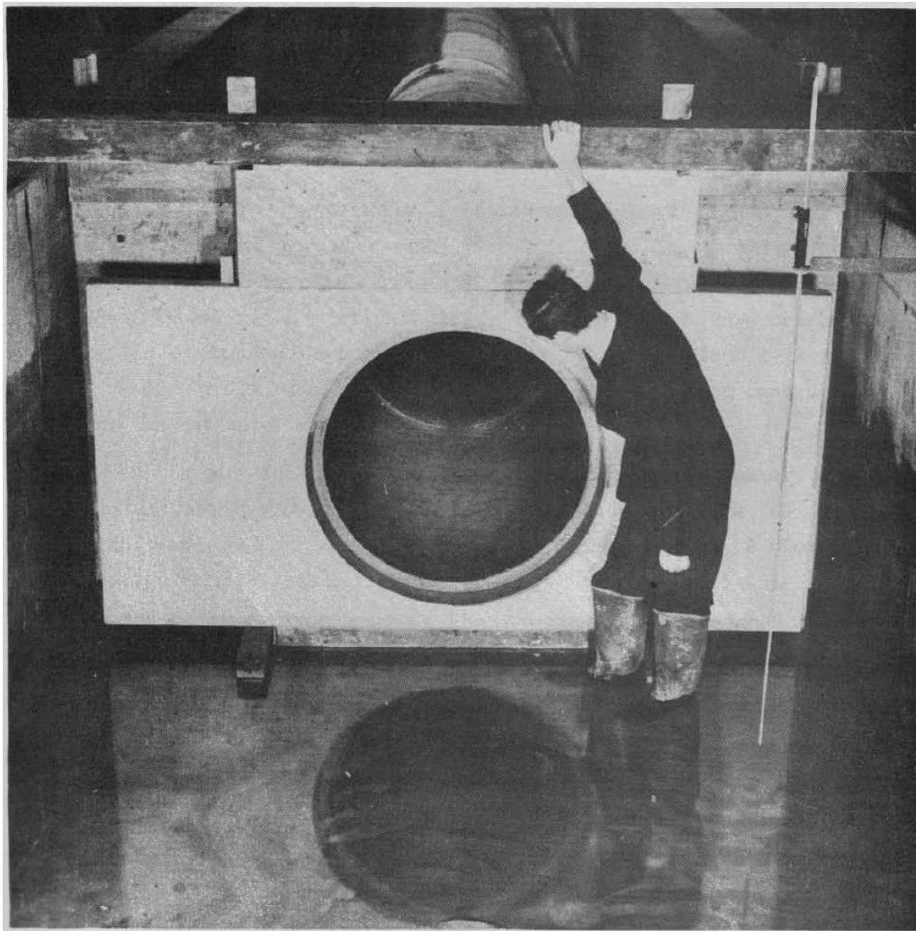
Obr. 23 Model betonového propustku s průměrem 36 palců v hydraulické laboratoři při výzkumu v polovině 20. stol.; modelovaná geometrie vtoku – kolmá čelní stěna
