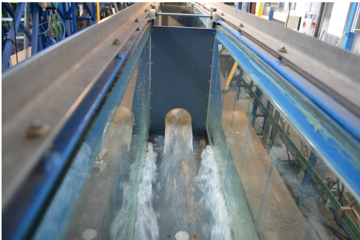
Obr. 92 Volný výtok z propustku při průtoku 15,3 l/s, což byla maximální kapacita modelu s vtokem I
