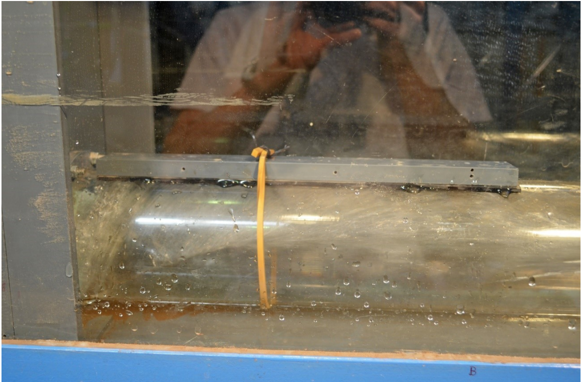
Obr. 94 Utěsnění měřících otvorů v rouře modelu pomocí gumové podložky, plastového dílce a gumy
