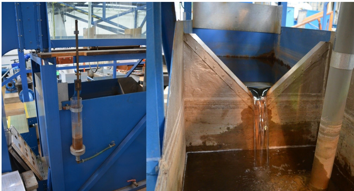
Obr. 58 Vlevo: svislé hrotové měřítko s jehlou ve tvaru háku v tlumícím válci; vpravo: Thomsonův měrný přeliv instalovaný ve žlabu B25
