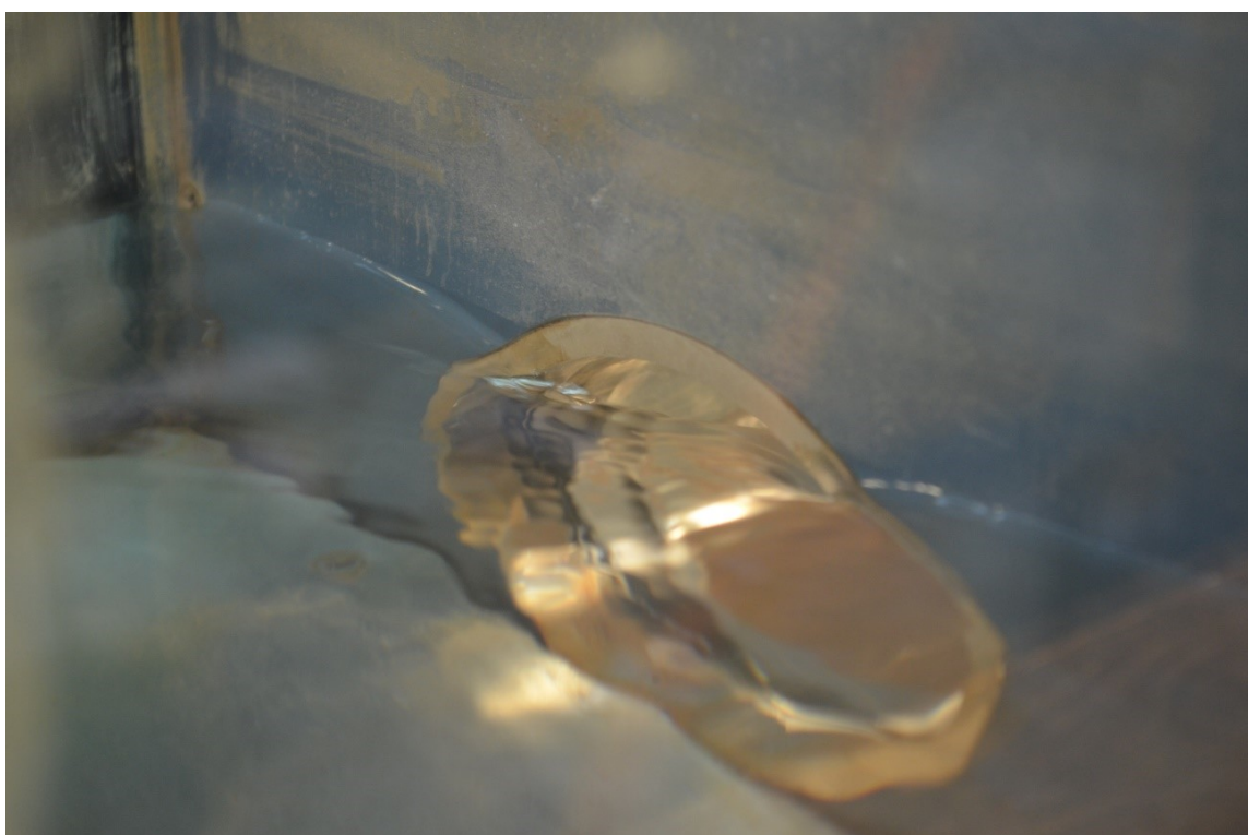
Obr. 93 Snížení hladiny před vtokem při průtoku 4,5 l/s (vtok I)
