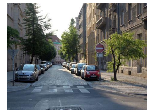
079 Jednosměrná zklidněná ulice s obousměrným provozem jízdních kol, kdy charakter dotváří stromořadí (Praha).
