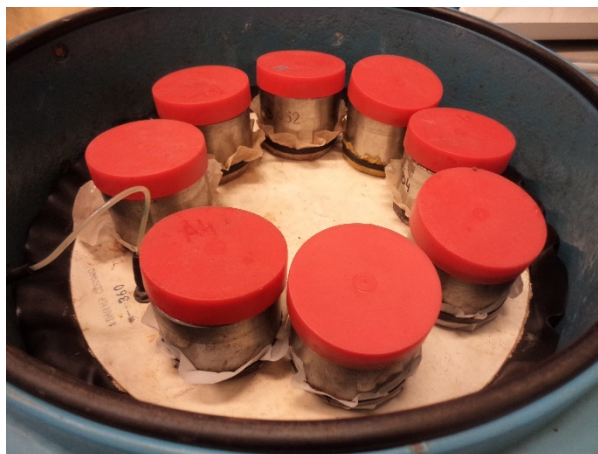
Obrázek 22 - Přetlakový aparát a uložení vzorků půdy v něm
