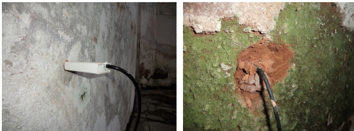
Obrázek 30 - detail umístění ve zdivu: čidlo vlhkosti CS 650 (vlevo), čidlo potenciálu MPS-6 (vpravo)
