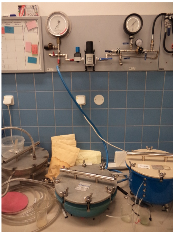
Obrázek 22 - Přetlakový aparát a uložení vzorků půdy v něm
