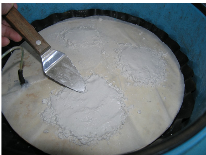
Obrázek 23 - Příprava pískového lože na keramické desce a uložení vzorku na něj
