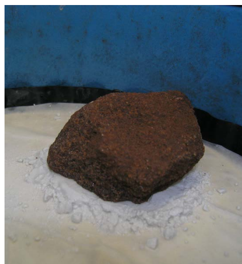
Obrázek 23 - Příprava pískového lože na keramické desce a uložení vzorku na něj
