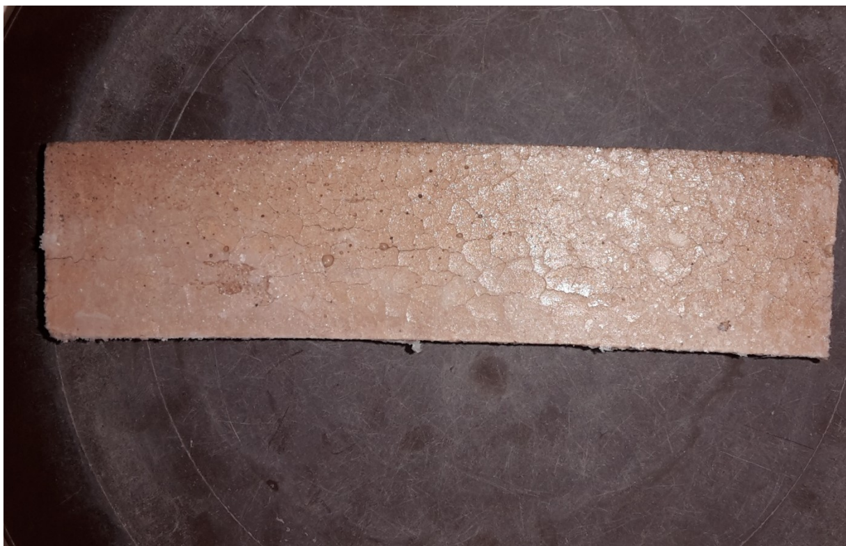
Obr. 17 Objemové změny malty CP po 180 dnech, na obrázku jsou dobře patrné trhliny
