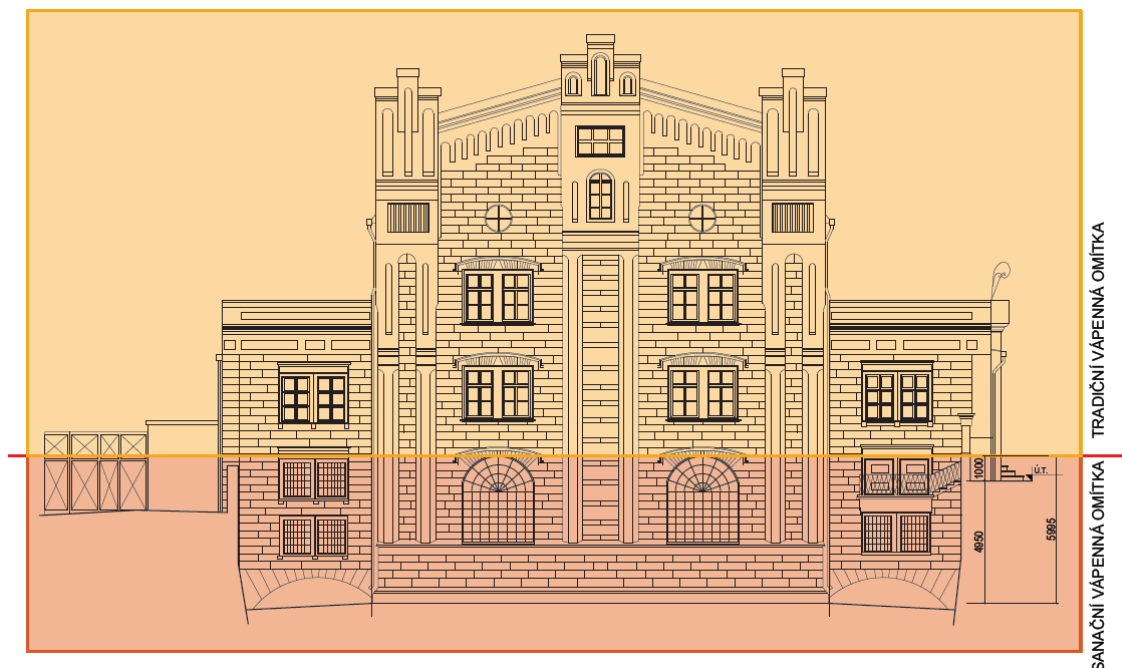
Obr. č. 36 _ Vyznačení výšky sanační omítky na severozápadní fasádě (vlastní zdroj)
