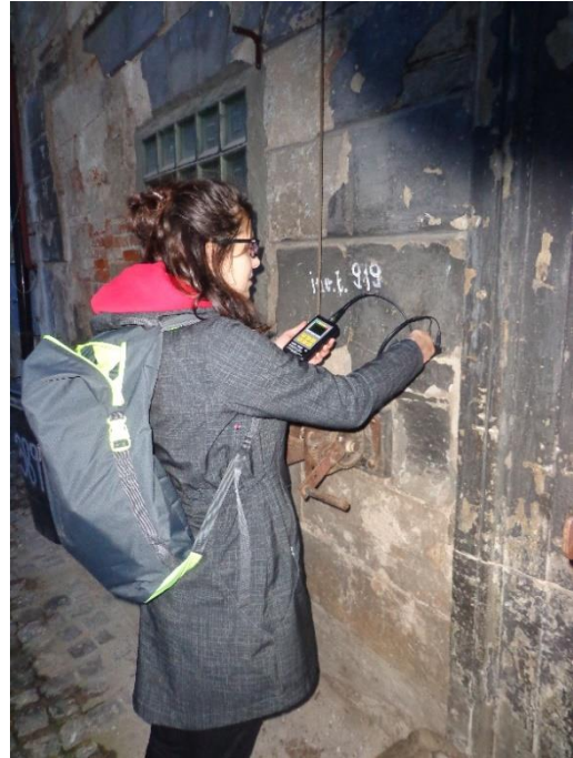
Obr. č. 48 - 49 _ Průběh měření odporovým měřiče Greisinger Electronic GHM 3850 (vlastní zdroj)
