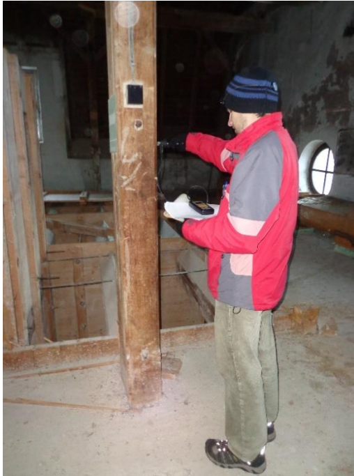
Obr. č. 48 - 49 _ Průběh měření odporovým měřiče Greisinger Electronic GHM 3850 (vlastní zdroj)
