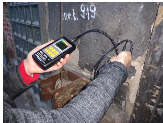
Obr. č. 50 – 51 _ Průběh měření odporovým měřiče Greisinger Electronic GHM 3850 (vlastní zdroj)
