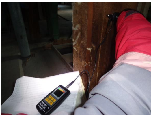
Obr. č. 50 – 51 _ Průběh měření odporovým měřiče Greisinger Electronic GHM 3850 (vlastní zdroj)
