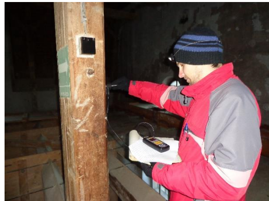
Obr. č. 51 - 52 _ Průběh měření odporovým měřiče Greisinger Electronic GHM 3850 (vlastní zdroj)
