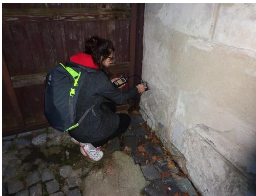
Obr. č. 51 - 52 _ Průběh měření odporovým měřiče Greisinger Electronic GHM 3850 (vlastní zdroj)
