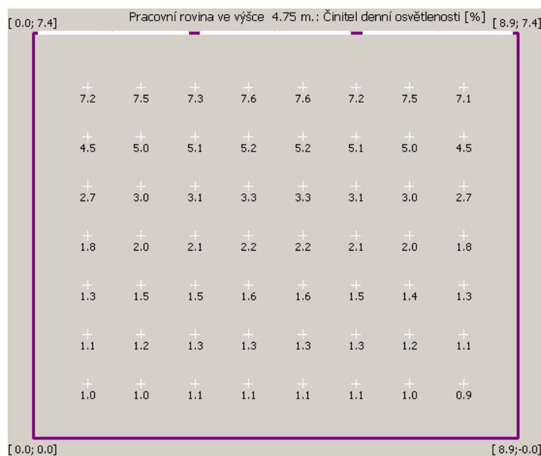
Obr 61 – Hodnoty činitele denní osvětlenosti pro učebnu 4 s naměřenými činiteli odrazu
