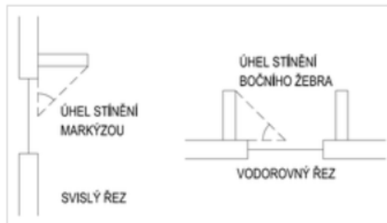
Obr. 2: Stínění markýzou a bočními žebry
