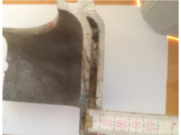
Obr. 1.37 Prasklá spalovací komora kondenzačního plynového kotle (autor)
