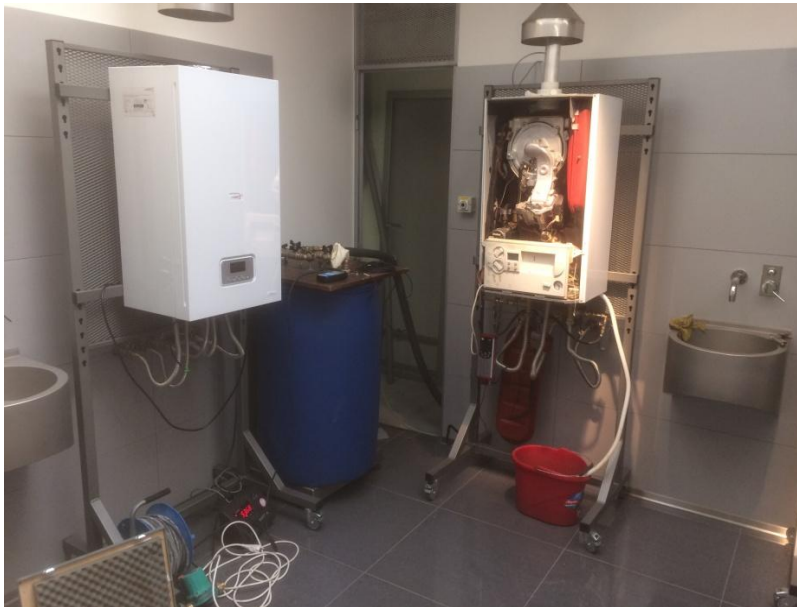
Obr. 1.18 Zapojení zdroje v testovacím okruhu s odběrnou nádobou (autor)
