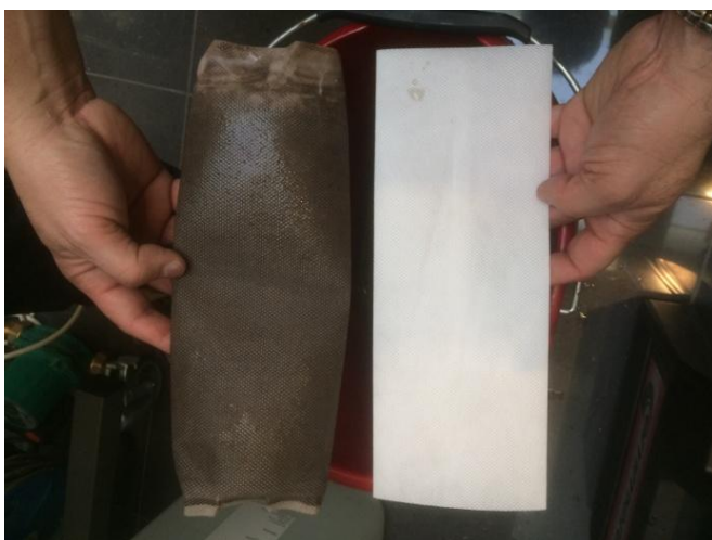
Obr. 1.20 Porovnání čisté a použité filtrační vložky (autor)
