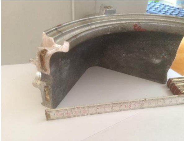
Obr. 1.37 Prasklá spalovací komora kondenzačního plynového kotle (autor)
