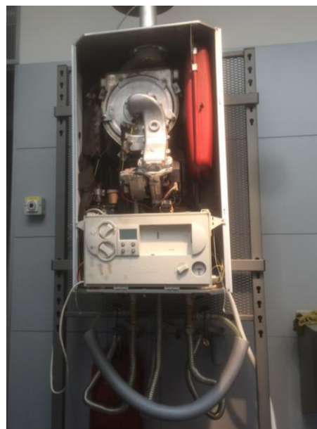
Obr. 1.21 Měření tepelné ztráty okruhu (autor)
