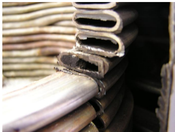
Obr. 1.23 Řez zaneseným výměníkem (Václav Eberl, Vaillant Group Czech)
