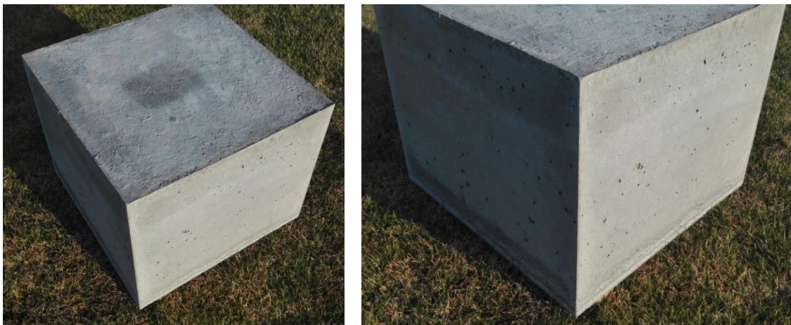
Obr. 8.3 Odbedněný ponton, detail povrchu
