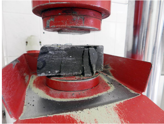
Obr. 7.13 Zkouška zlomků trámečků v tlaku
