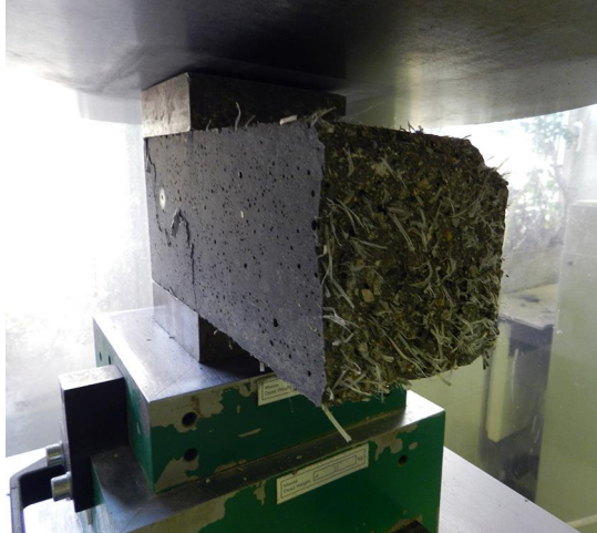
Obr. 7.12 Zkouška zlomků trámčů v tlaku
