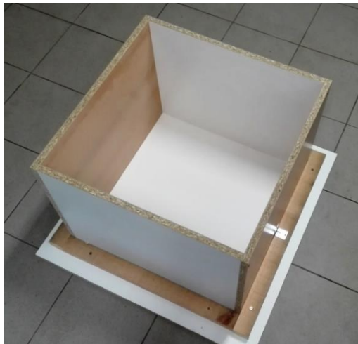
Obr. 8.1 Bednění pilotního vzorku
