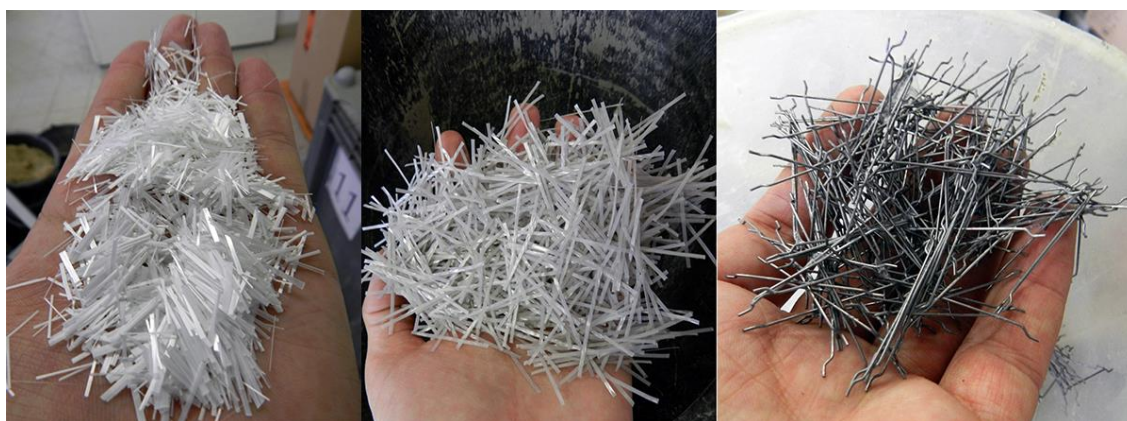
Obr. 7.1 Fotografie použitých vláken: a) skleněná vlákna, b) polymerová vlákna, c) ocelové drátky
