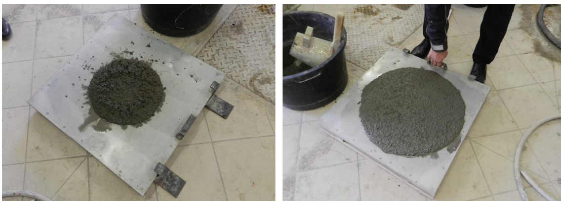
Obr. 7.4 Zkouška rozlitím referenční záměsi (vlevo před střešáním, vpravo finální rozlití)
