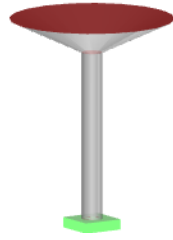
Obrázek 32 Prvotní model hlavice prutový prvek s náběhem
