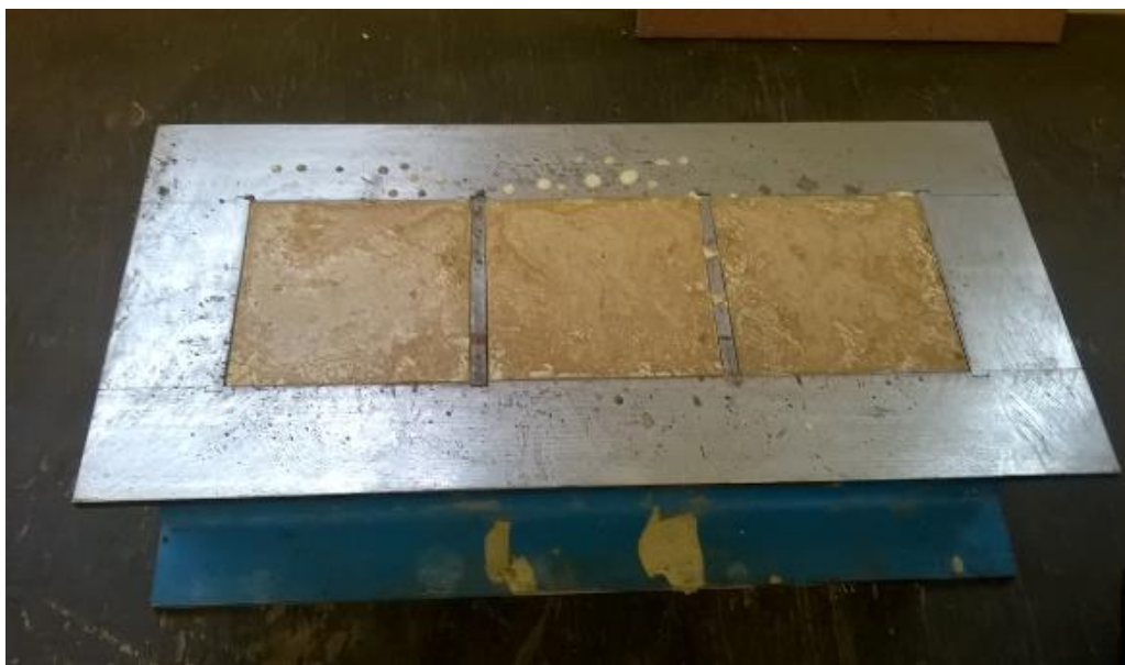
Obr. 25 - Forma s čerstvým betonem
