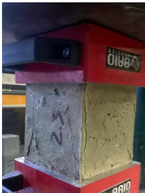
Obr. 27 – Porušený vzorek při zkoušce v tlaku
