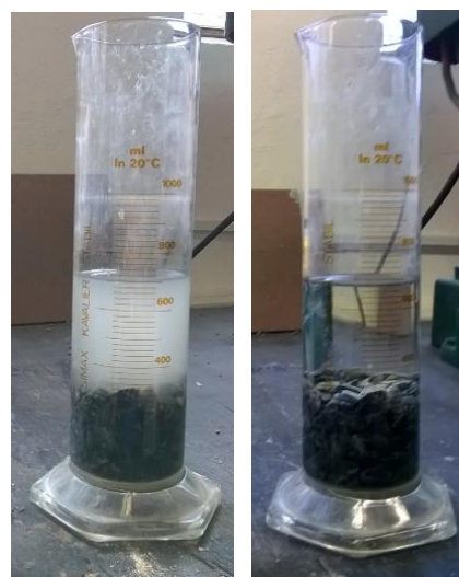
Obr. 24 - Kamenivo po přidání do vody a po 24 hodinách
