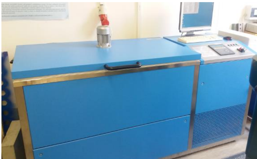
Obr. 42 – Automatické programovatelné cyklovací zařízení pro zkoušení povrchu betonu proti působení vody a chemických rozmrazovacích látek
