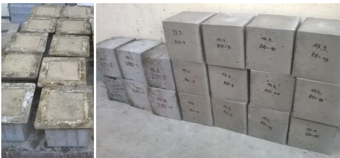
Obr. 38 - Výroba zkušebních krychlí o hraně 150 mm
