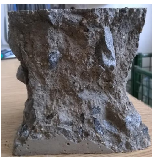
Obr. 31 – Porušený vzorek po zkoušce v tlaku
