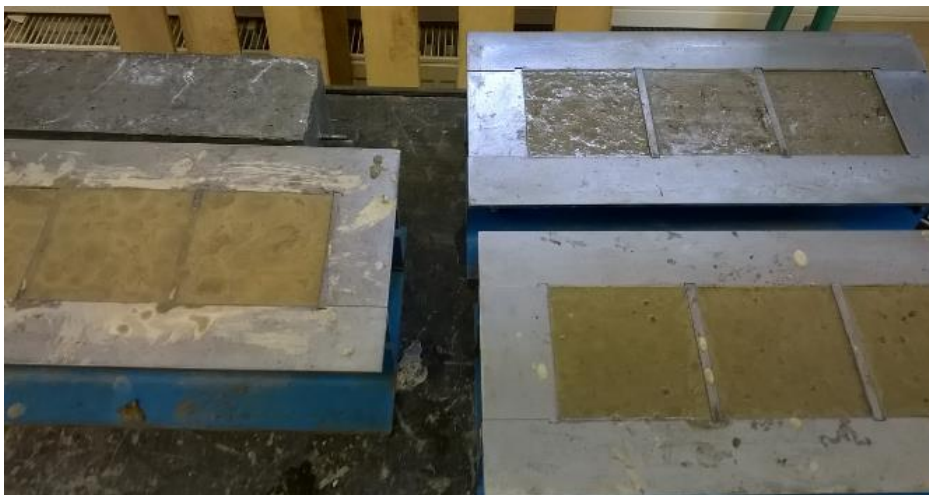
Obr. 29 – Čerstvý beton ve formách
