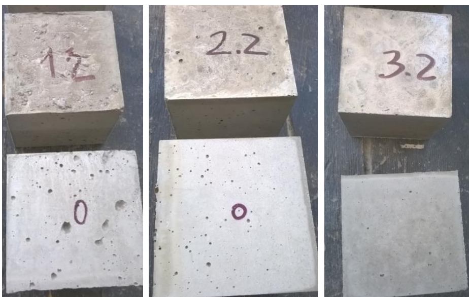
Obr. 30 – Zkušební krychle o hraně 100 mm, receptury N4, N5a, N5b
