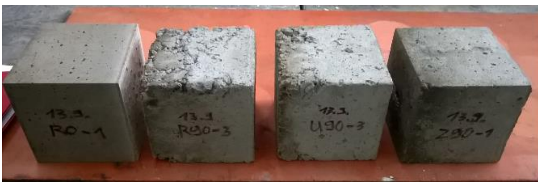
Obr. 39 – Rozdíl v kvalitě povrchů jednotlivých krychlí
