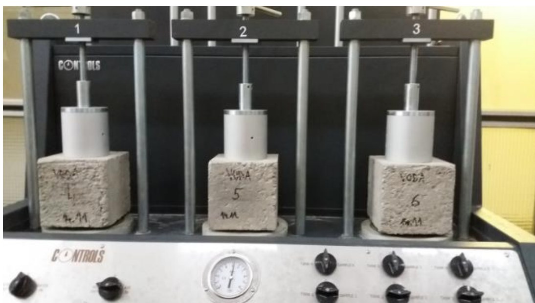
Obr. 64 – Krychle N12b upnuté do zkušebního zařízení v průběhu zkoušky
