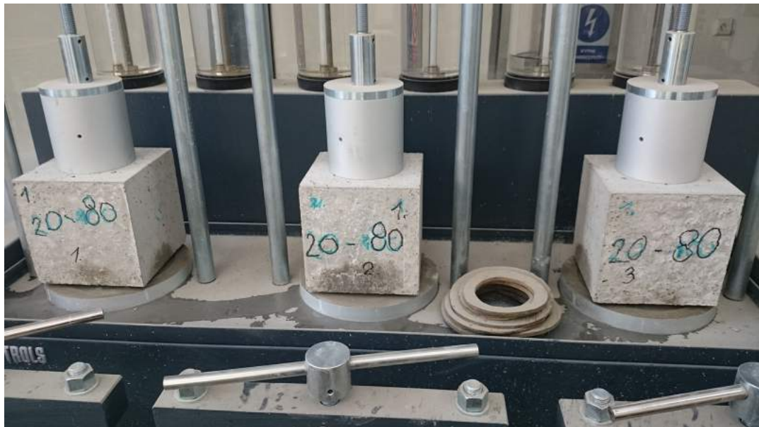
Obrázek 7.22: Zkouška hloubky průsaku tlakové vody na vzorcích GUM 20/80
