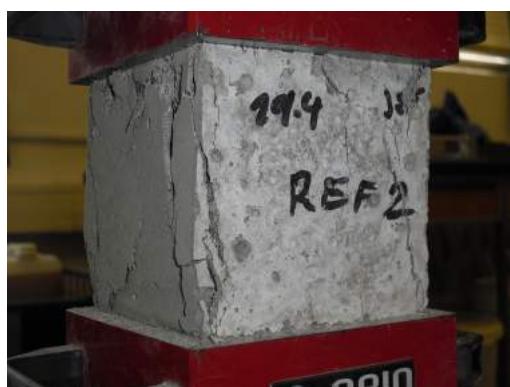
Obrázek 6.6: Vzorek po tlakové zkoušce Obrázek 6.7: Vzorek po tlakové zkoušce
