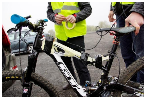
Obrázek 40: Uchycení snímačů na rám kola
