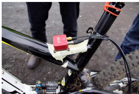
Obrázek 39: Snímač SBG Systems – Ellipse2-N
