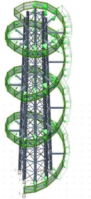
Obrázek 16 - Rozložení zatížení větrem na zábradlí – celkový pohled
