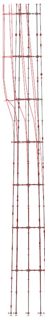
Obrázek 21 - První vlastní tvary vybočení sloupů
