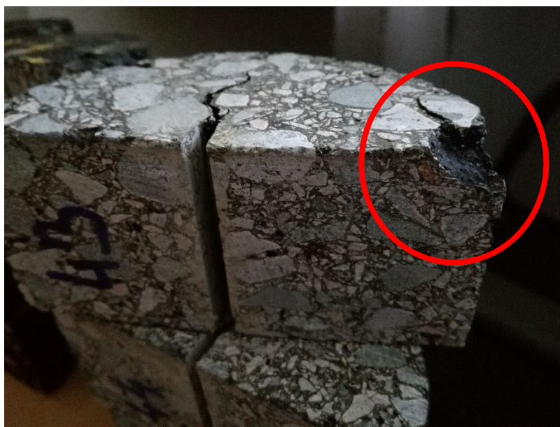
Obrázek 28: Drcení tělesa v místě uložení na zkušební zařízení
