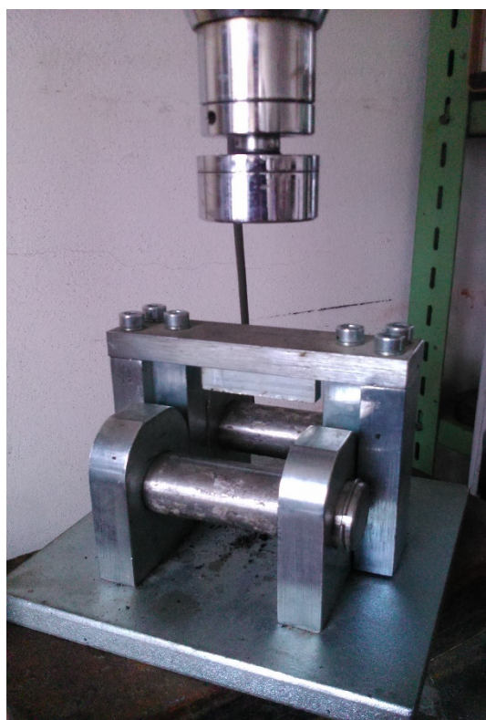
Obrázek 26: Zkušební zařízení pro zkoušku šíření trhliny na půlválcovém zkušebním tělese
