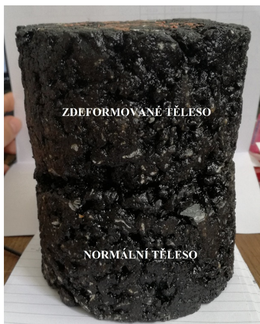
Obrázek 29: Zdeformované těleso metodou PAV
