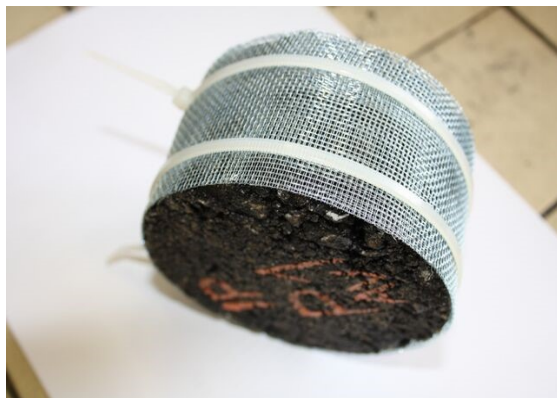
Obrázek 5: Těleso zajištěné proti nežádoucí deformaci [10]
