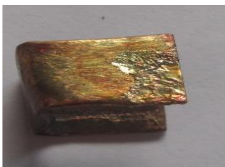
obrázek O.11.3 - opotřebení vystřeleného projektilu s tvarovaným přítlakem.
