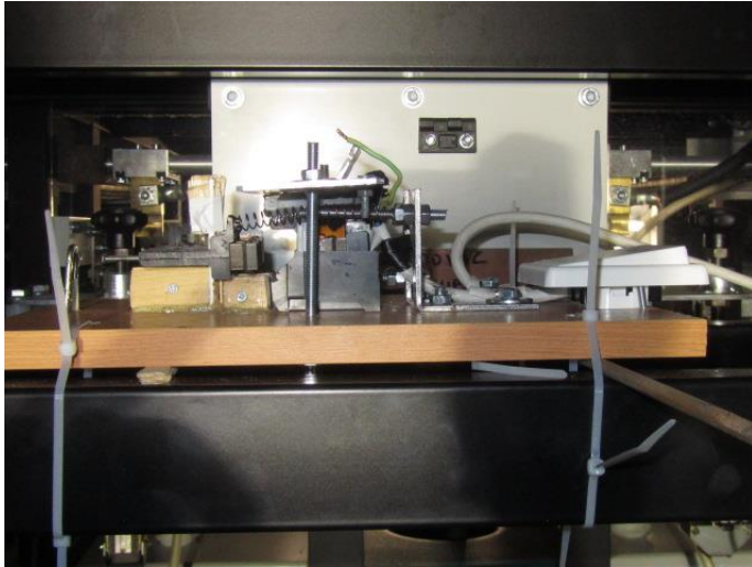
O.15.5.2 – předurýchlovač připevněný na konstrukci navazující na hlaveň
