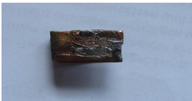
obrázek O.11.4 - patrné následky elektrického oblouku, který při výstřelu hořel mezi projektilem a kolejnici
