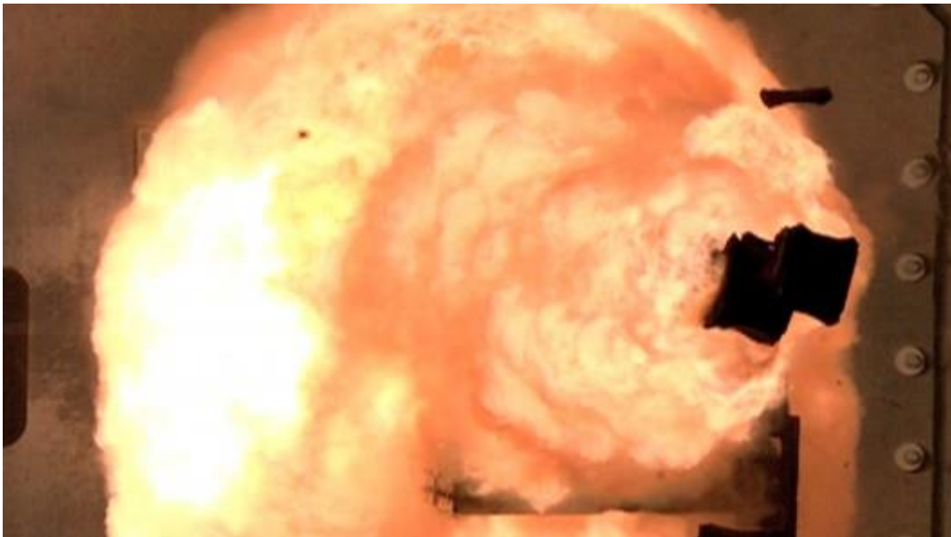
obrázek O.10.2.1 - projektil s přímým tvarovaným kontaktem vystřelený z railgunu US Navy a patrný plasmový oblak, převzatý z [8]
