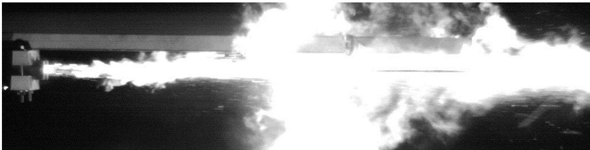
O.15.3.4.5 - plasmatický oblak po výstřelu projektilu se smíšeným plasmatickým vedením II
