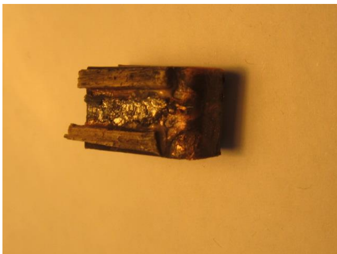
O.15.3.4.3 - projektil se smíšeným vedením proudu pomocí plasmy a kovu, vyfotografovaný po výstřelu
