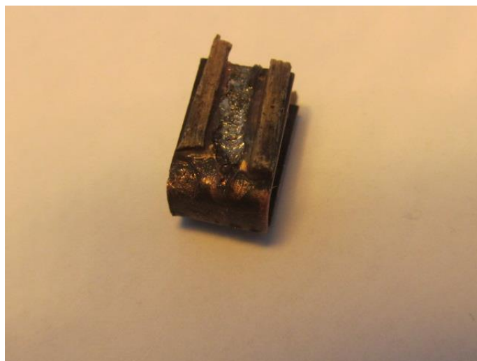
O.15.3.4.3 - projektil se smíšeným vedením proudu pomocí plasmy a kovu, vyfotografovaný po výstřelu
