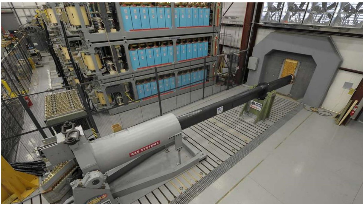
obrázek O.10.3.1 - kondenzátorové baterie (modře) pro napájení railgunu, urychlující 18Kg projektil na rychlosti okolo 1700 m/s, převzatý z [8]
