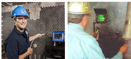
Obr. 1 Zkouška vířivými proudy
