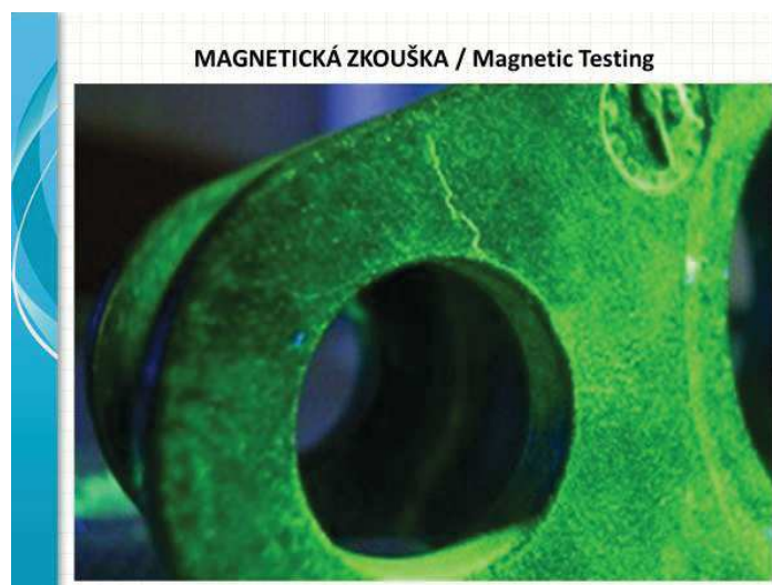
Obr. 12.4.2 Magnetická zkouška prášková (fluorescenční)
