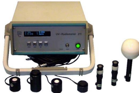
Obr. č. 12 – Digitální luxmetr a radiometr PRC Krochmann 211 s čidly [21]
