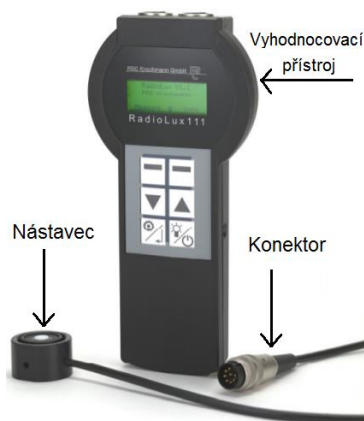
Obr. č. 6 - Luxmetr PRC Krochmann Radiolux 111 s popisem jeho součástí
