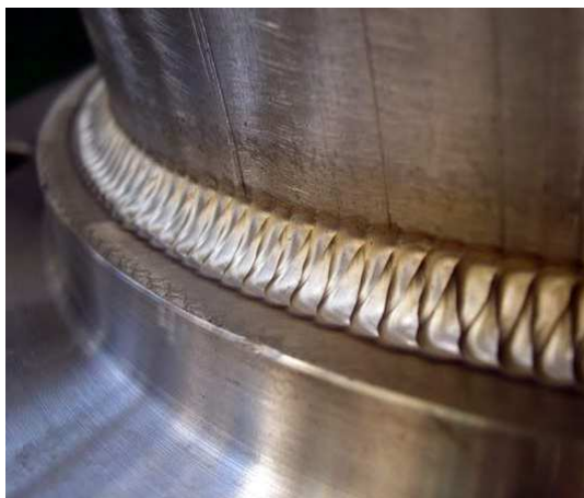
Obrázek 15: Koutový svar na trubce metodou TIG [24]
