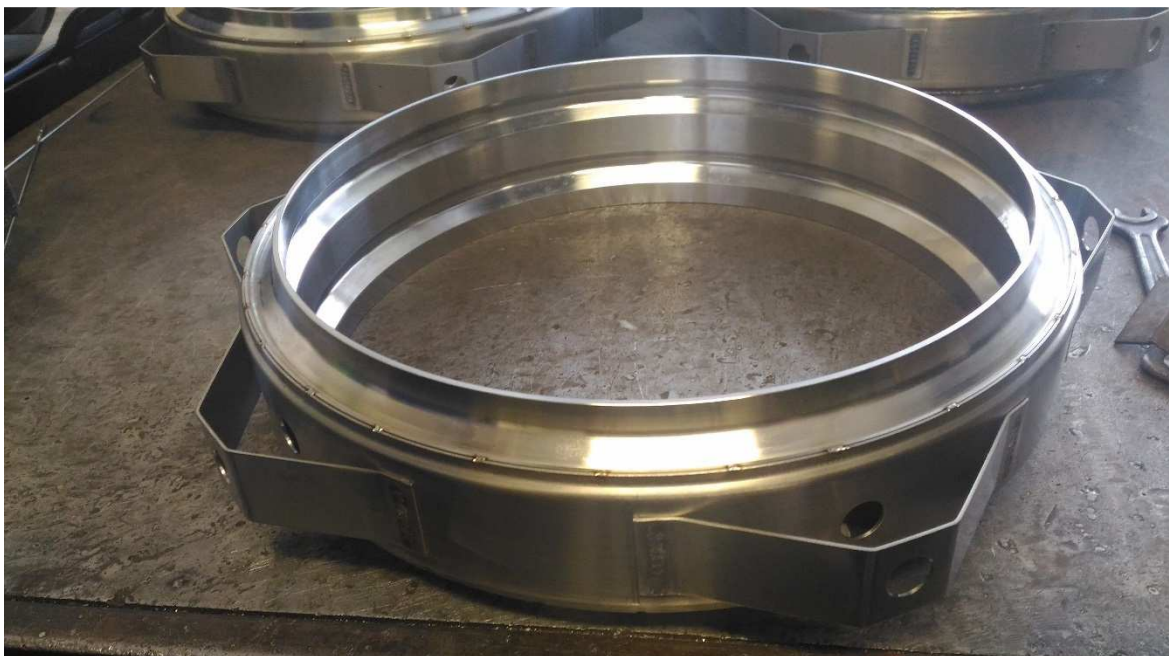
Obrázek 27: Sestavený ochranný kryt připravený pro svařování, poloha dílů byla zajištěna stehmi
