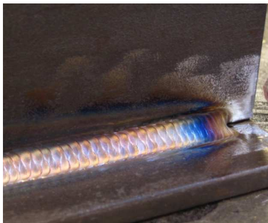
Obrázek 16: Koutový svar na plechu metodou TIG [25]
