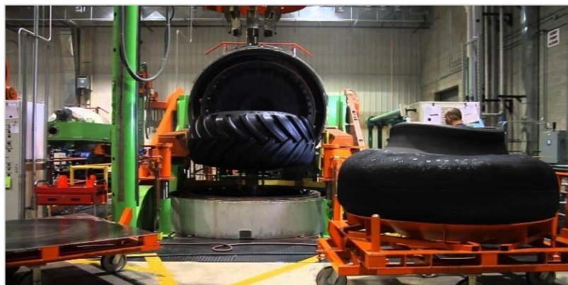
Obr. 3.1.5.0 Pohled na vulkanizační lis, uprostřed vylisovaná pneumatika, napravo připravená karkasa (zdroj: TS Plzeň a.s., 2013)
