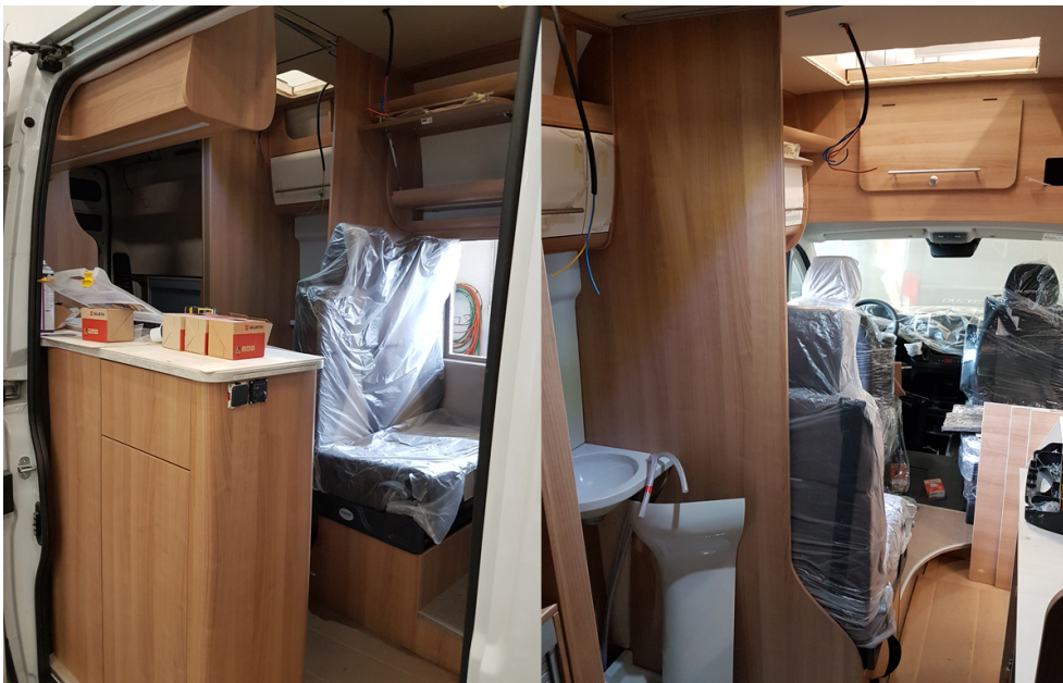
Obrázek 4.6: Výroba obytné vestavby pilotního automobilu
