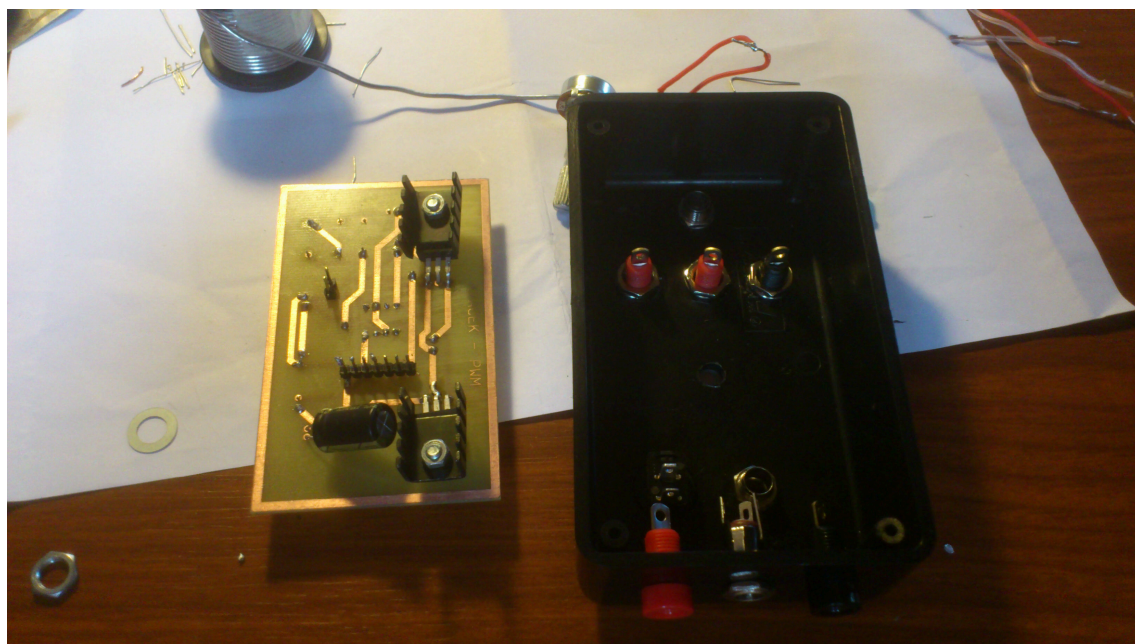
Obrázek A.3: Připravený a osazený plošný spoj a instalační krabice
