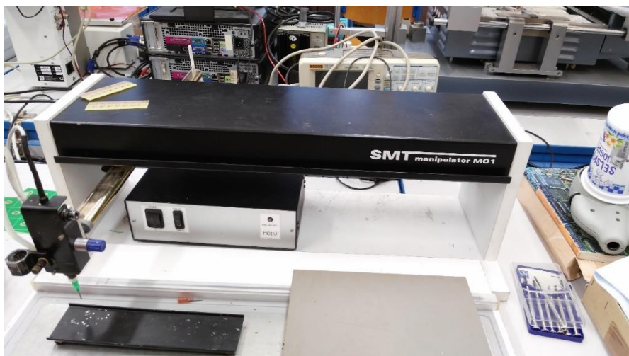
Obr. 13 Vakuový manipulátor pro přesné usazení SMT součástek
