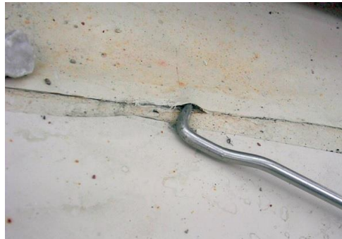
Obr. 23 - Zkouška těsnosti spojů pomocí izolačské jehly (převzato z [3])
