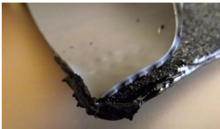
Obr. 40 - Degradace asfaltu a hydroizolační fólie (převzato z [19])
