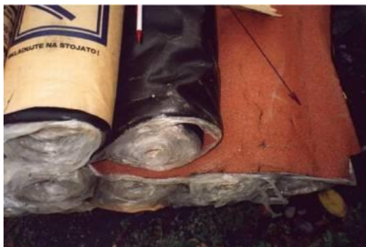
Obr. 24 - Nevhodné skladování asfaltového pásu na ležato (převzato z [21])
