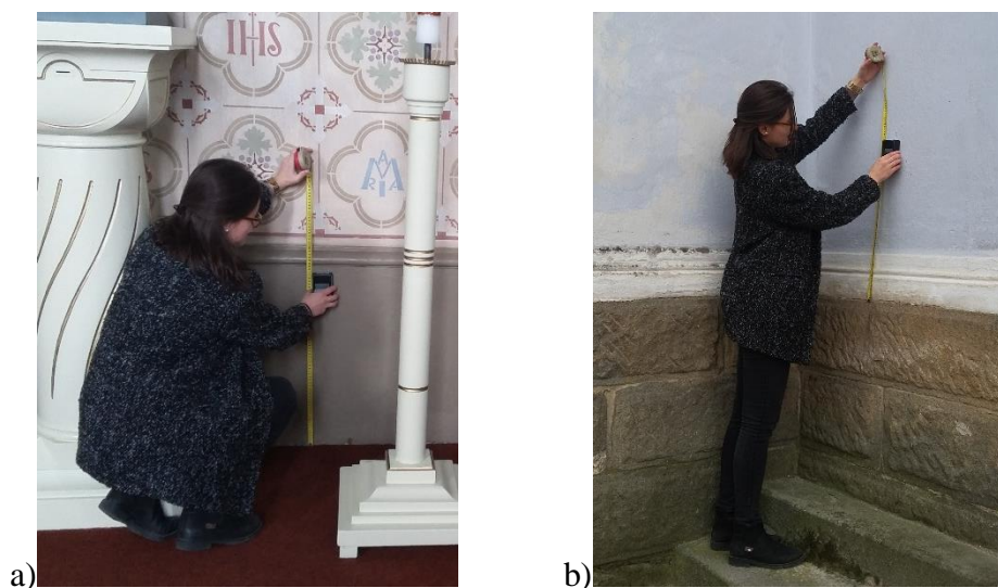
Obr. 37: Měření vlhkosti zdiva pomocí kapacitního vlhkoměru a) v interiéru, b) v exteriéru
