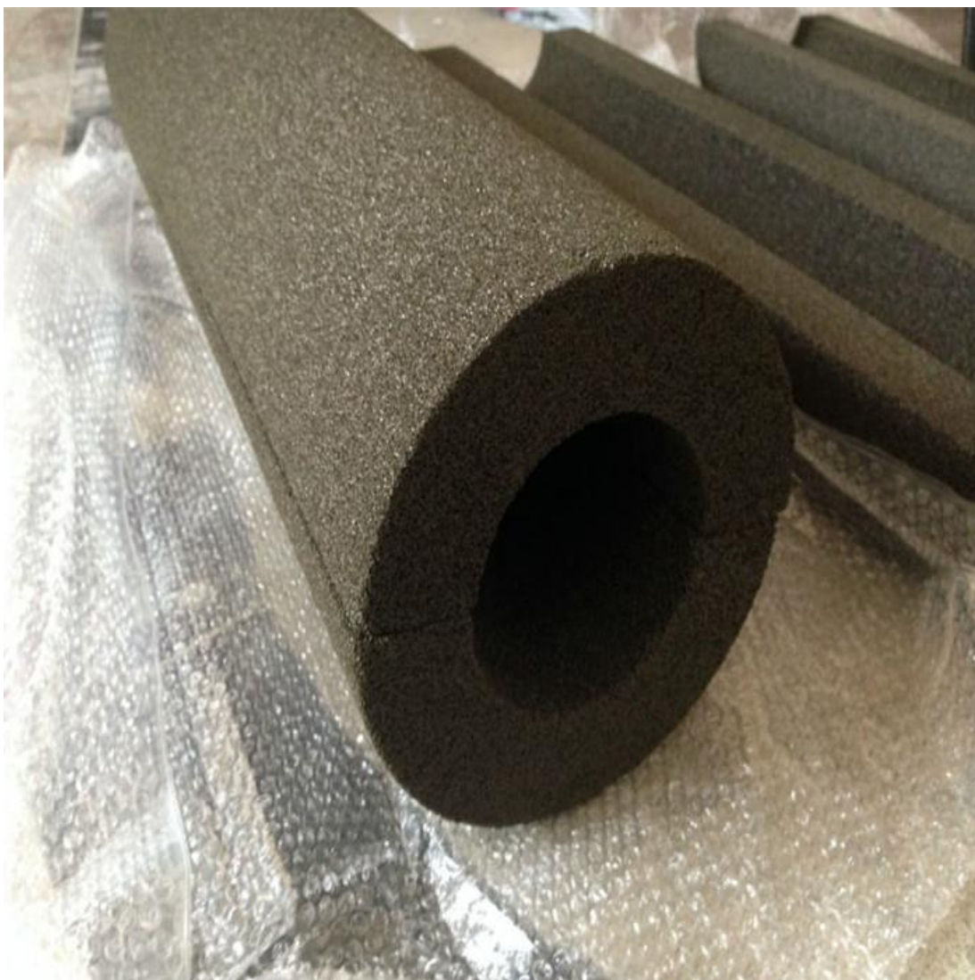
Obr. 6 : Potrubní izolace z pěnového skla (17)
