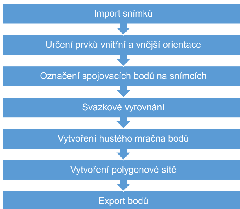
Obrázek 39 Schéma postupu zpracování v programu Agisoft PhotoScan
