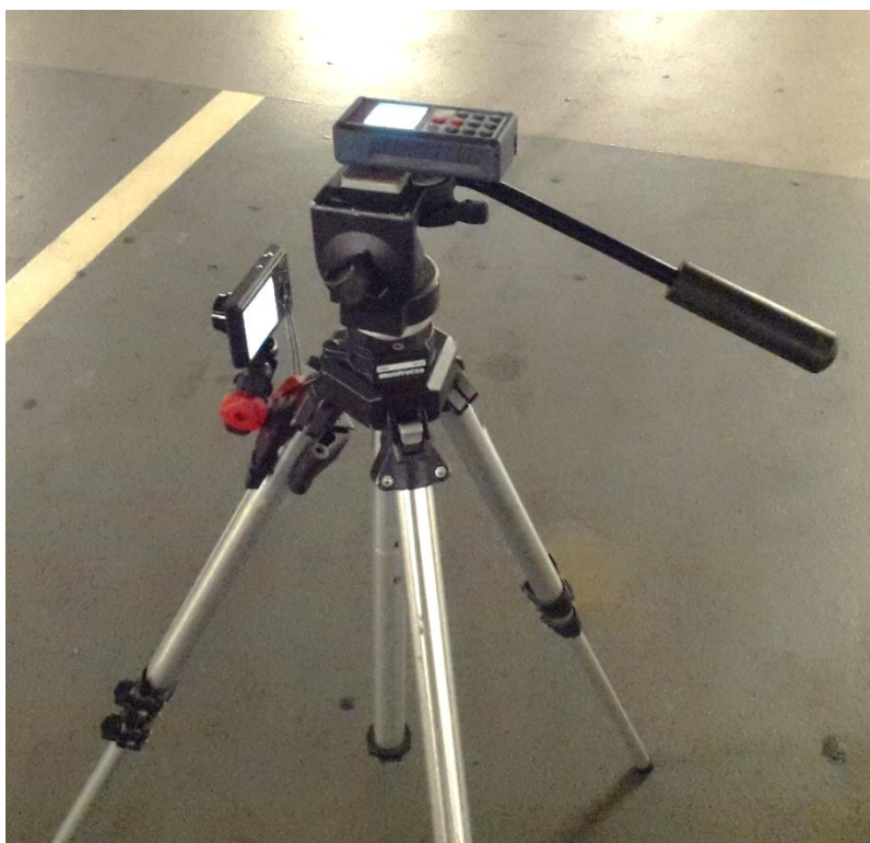
Obrázek 21 Sestava pro měření s využitím laserového měřiče vzdálenosti
