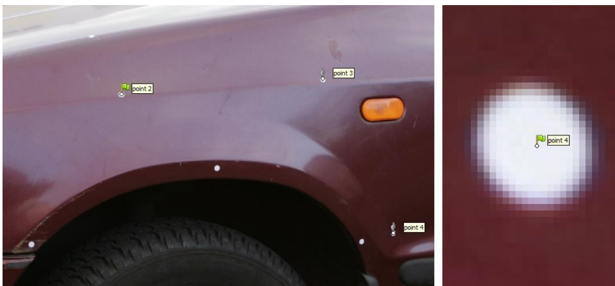
Obrázek 34 Určení spojovacího bodu s použitím kruhového terčíku
