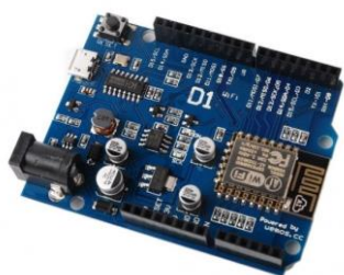
Obr. 6.2 WeMos D1, převzato z [43].
