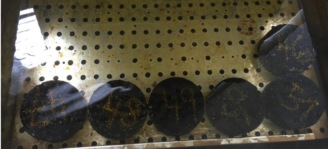
Obrázek 6. 14 – Sycení těles ve vodní lázni o teplotě 60 °C
