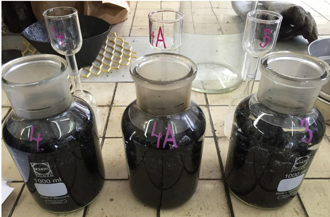
Obrázek 6. 11 – Pyknometry po vyjmutí z vakuové nádoby
