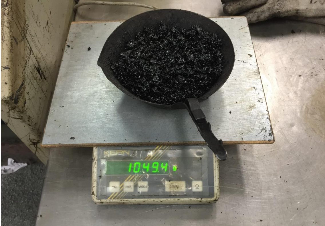
Obrázek 6. 4 – Navážení směsi pro výrobu jednoho zkušebního tělesa
