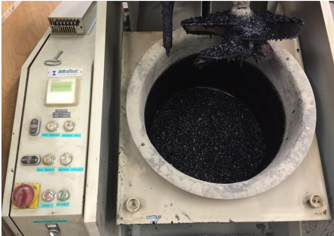
Obrázek 6. 5 – Výsledná směs v laboratorní míchačce
