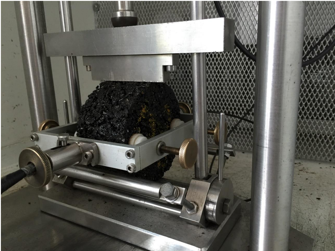
Obrázek 6. 12 – Upevnění tělesa do zkušebního rámečku při měření tuhosti
