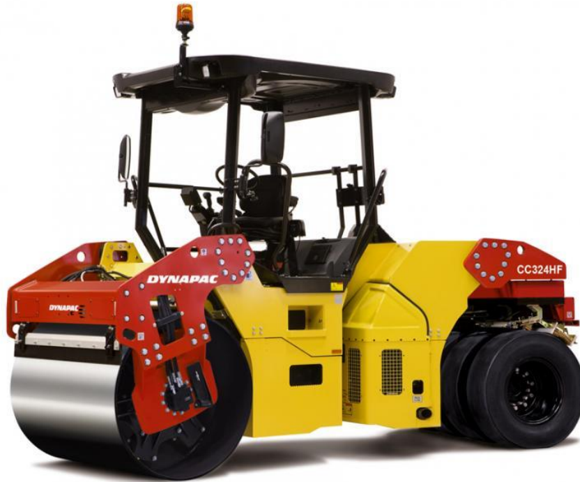
Obrázek 4. 11 – Kombinovaný válec Dynapac CC324 s předním vibračním běhounem a pneumatikami [20]
