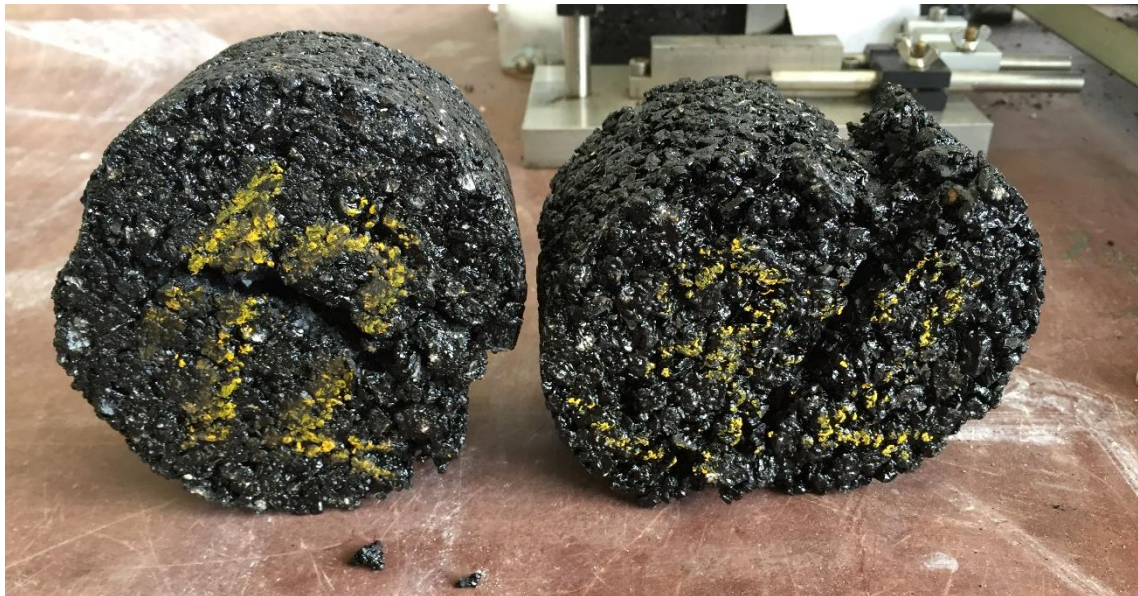
Obrázek 6. 13 – Zničení zkušebních těles při měření tuhosti
