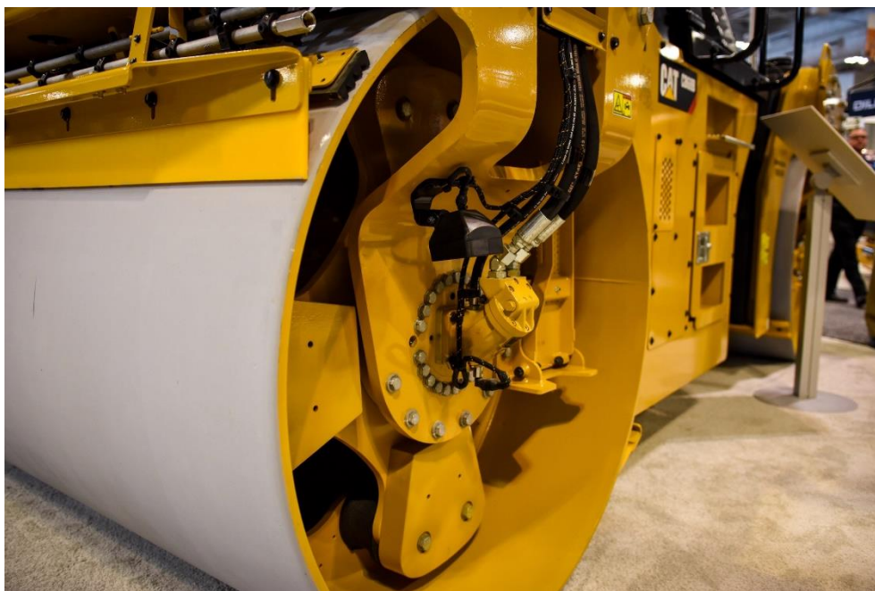
Obrázek 4. 6 – Vibrační systém tandemového dvouosého válce Caterpillar CB68B [11]
