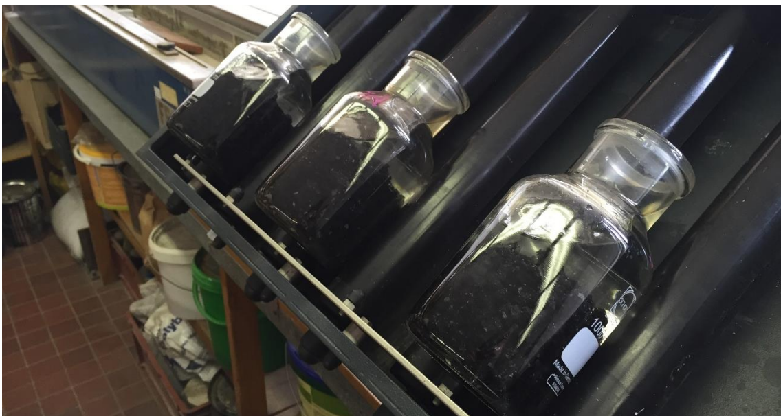
Obrázek 6. 10 – Pyknometry se směsí a destilovanou vodou na otáčecích válcích
