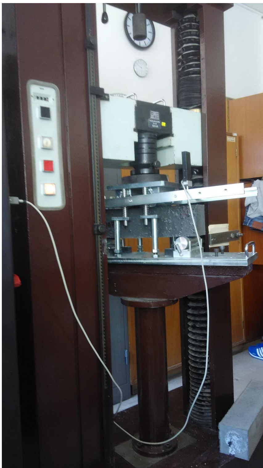
Obr. 21 – UHPC-I* bez zářezu v zatěžovacím lisu
