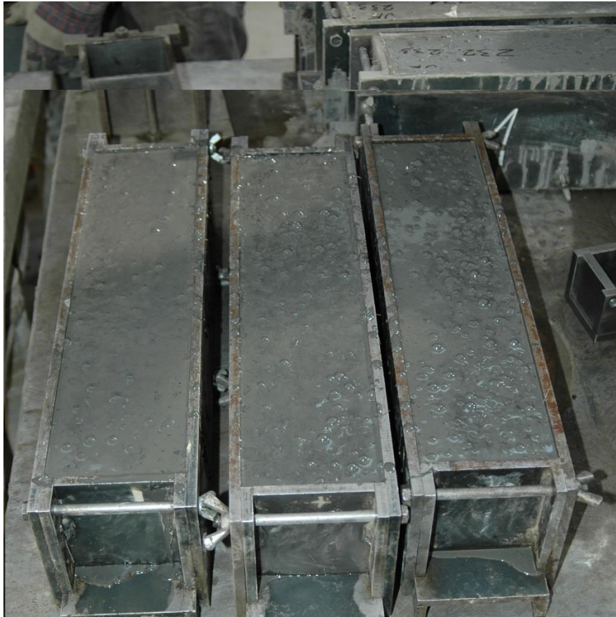
Obr. 4 – trámce bez zářezu v ocelové formě
