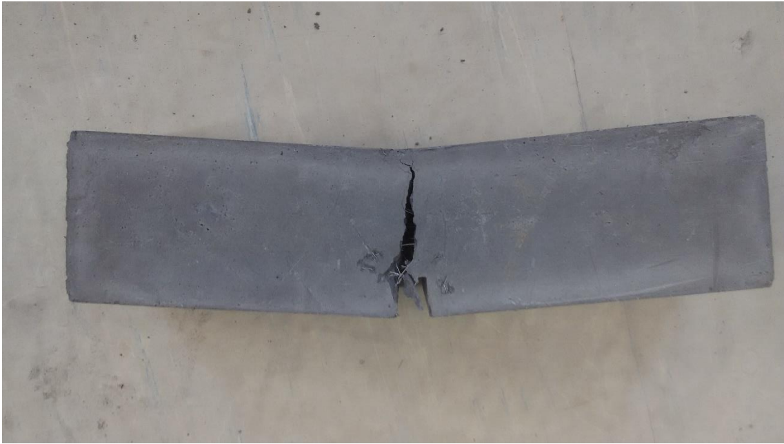
Obr. 22 – trámec UHPC-3* se zářezem
