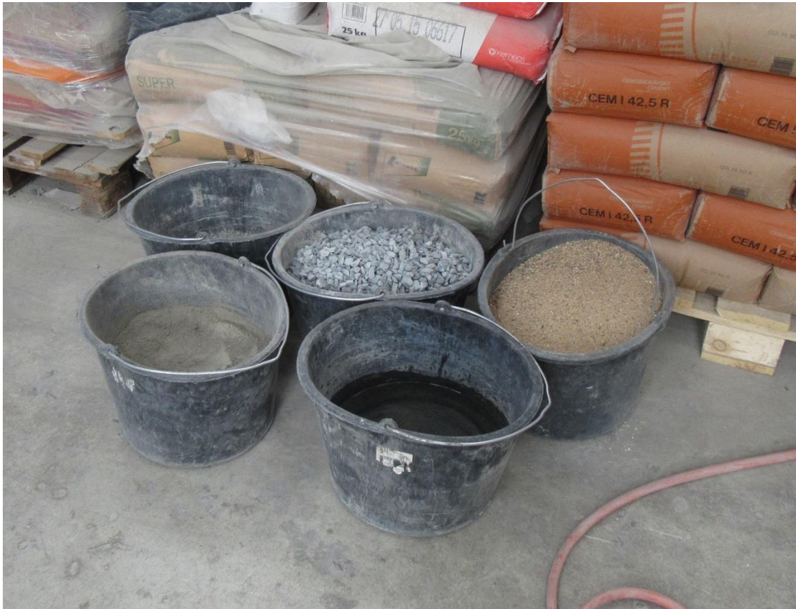
Obr. 6 – suroviny pro výrobu referenčního drátkobetonu
