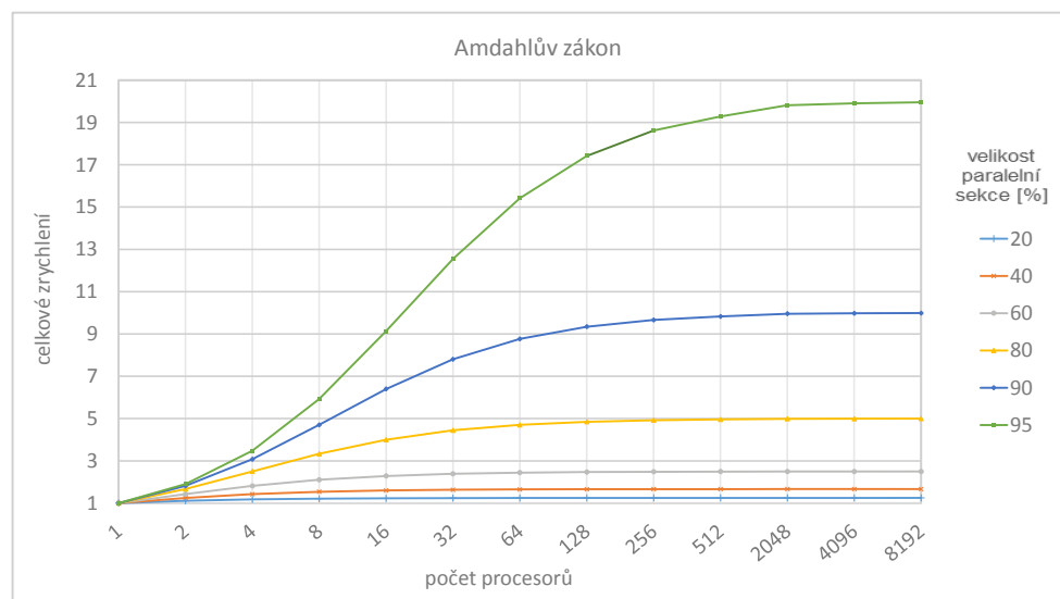
Obrázek 3.1: Amdahlův zákon - závislost zrychlení na počtu procesorů
