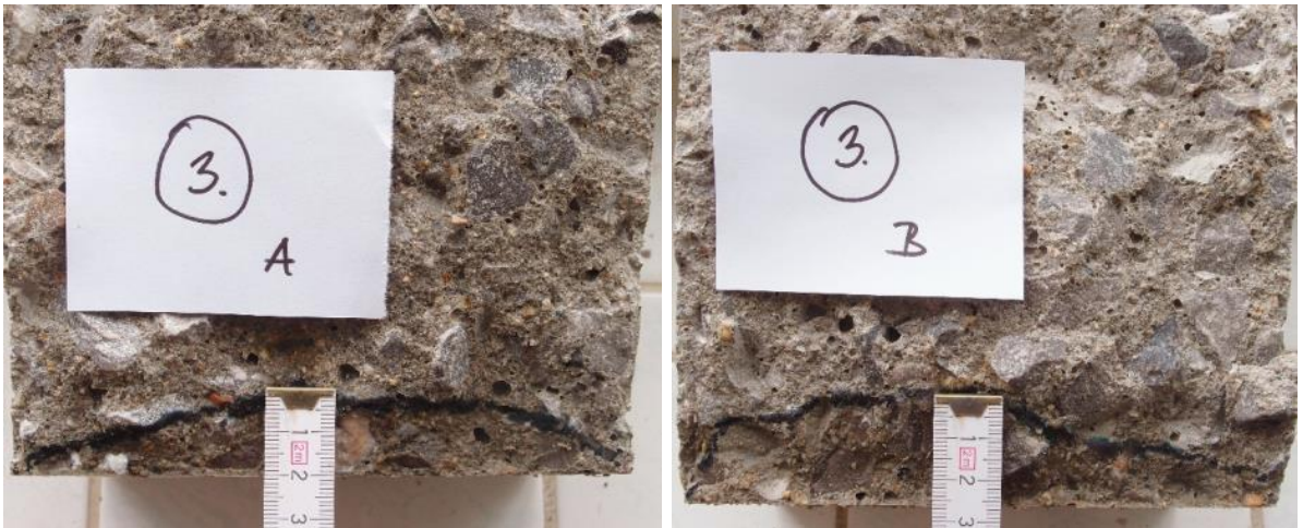
Obr. 49, 50: Průsaky tlakovou vodou dvou vzorků CEM A – vlevo 21 mm, vpravo 28 mm
