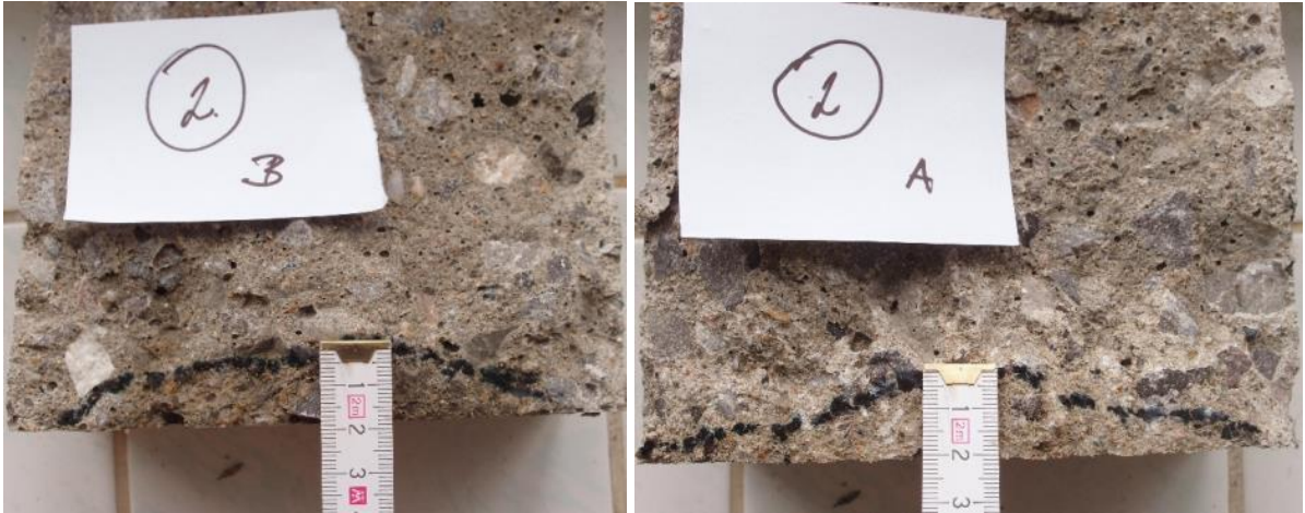
Obr. 47, 48: Průsaky tlakovou vodou dvou vzorků XYP A – vlevo 20 mm, vpravo 20 mm
