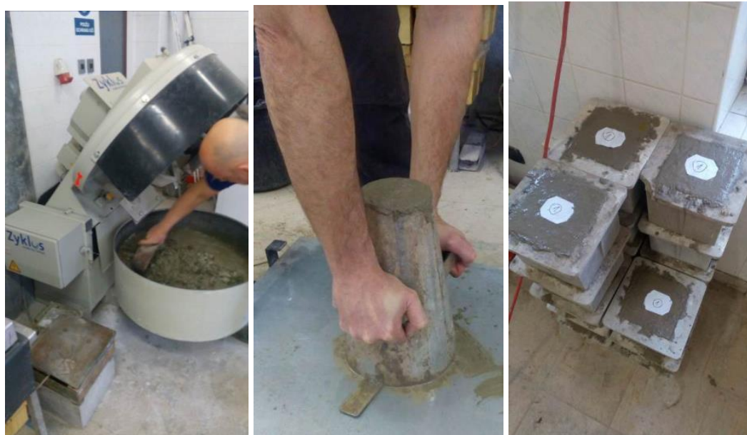
Obr. 17, 18, 19: Vlevo odebrání čerstvého betonu z míchačky, uprostřed ukázka provádění zkoušky sednutí kužele, vpravo odlitá a označená čerstvá záměs REF
