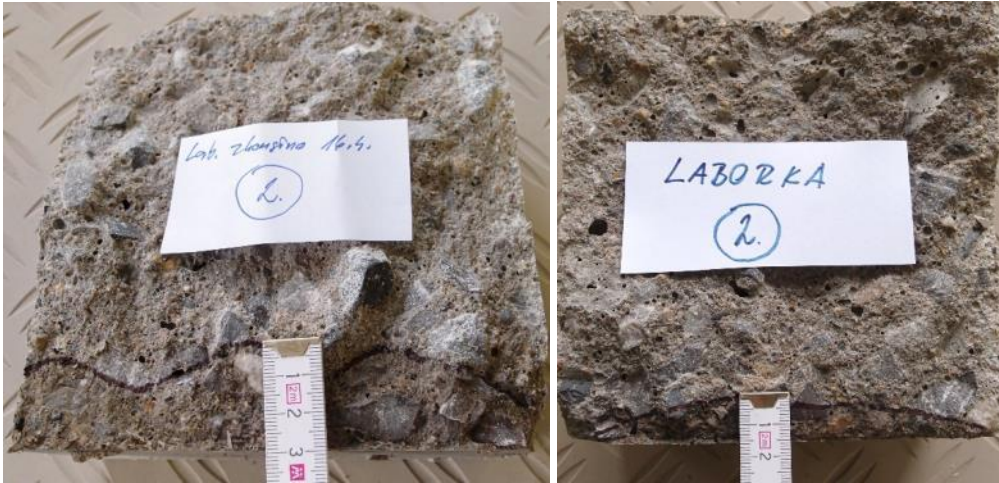
Obr. 59, 60: Průsaky tlakovou vodou dvou vzorků XYP C – vlevo 30 mm, vpravo 16 mm
