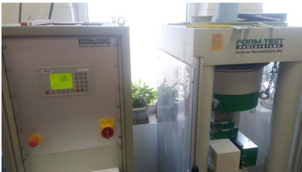
Obr. 43: Pohled na zatěžovací lis, vlevo ovládací panel s naměřenými hodnotami, vpravo zatěžovací lis s vloženým betonovým vzorkem
