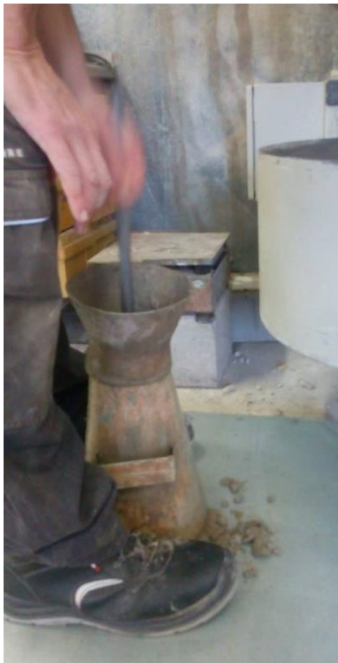
Obr. 33, 34: Vlevo hutnění betonu ukládaného do formy pro zkoušku sednutí kužele, vpravo plná forma před zvednutím
