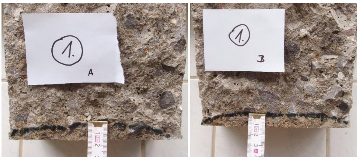
Obr. 45, 46: Průsaky tlakovou vodou dvou vzorků REF A – vlevo 17 mm, vpravo 13 mm
