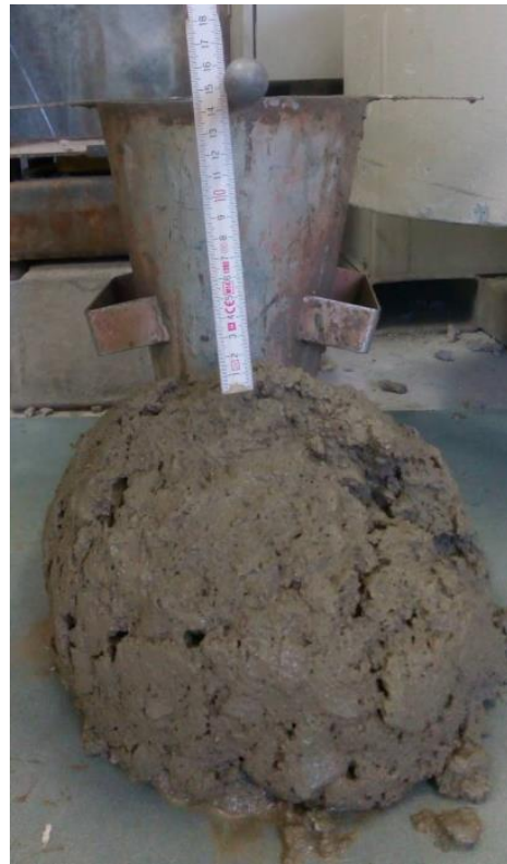
Obr. 35, 36: Sednutí REF – vlevo 5 minut 170 mm, vpravo 60 minut 150 mm
