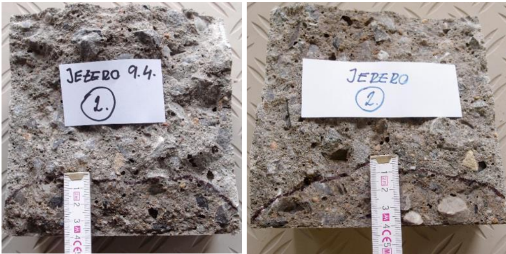
Obr. 53, 54: Průsaky tlakovou vodou dvou vzorků XYP B – vlevo 40 mm, vpravo 40 mm
