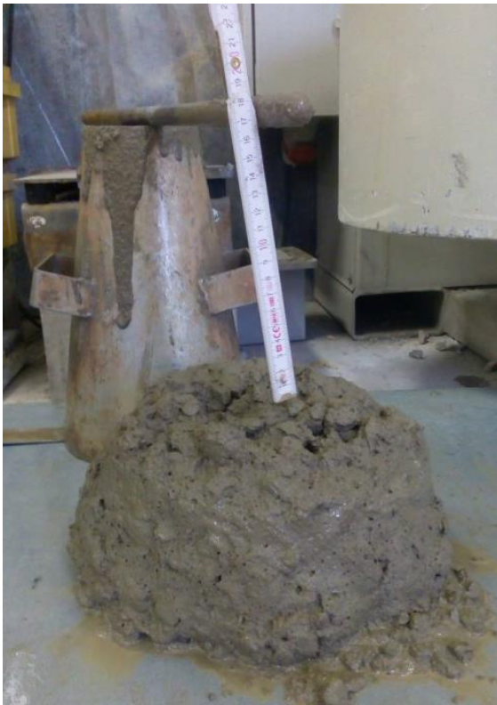
Obr. 35, 36: Sednutí REF – vlevo 5 minut 170 mm, vpravo 60 minut 150 mm
