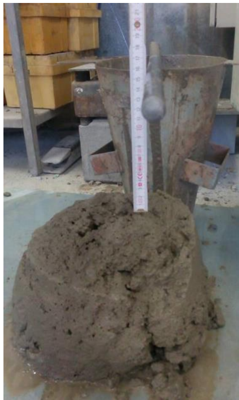
Obr. 37, 38: Sednutí XYP – vlevo 5 minut 180 mm, vpravo 60 minut 150 mm
