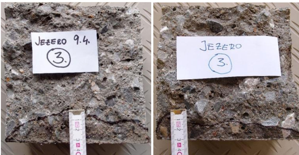
Obr. 55, 56: Průsaky tlakovou vodou dvou vzorků CEM B – vlevo 32 mm, vpravo 30 mm
