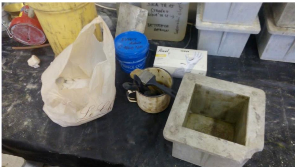
Obr. 16: Příprava forem betonových vzorků – zleva pěnové ucpávky do otvoru ve formě, odbedňovací prostředek, plastová forma pro normovou krychli o hraně 150 mm
