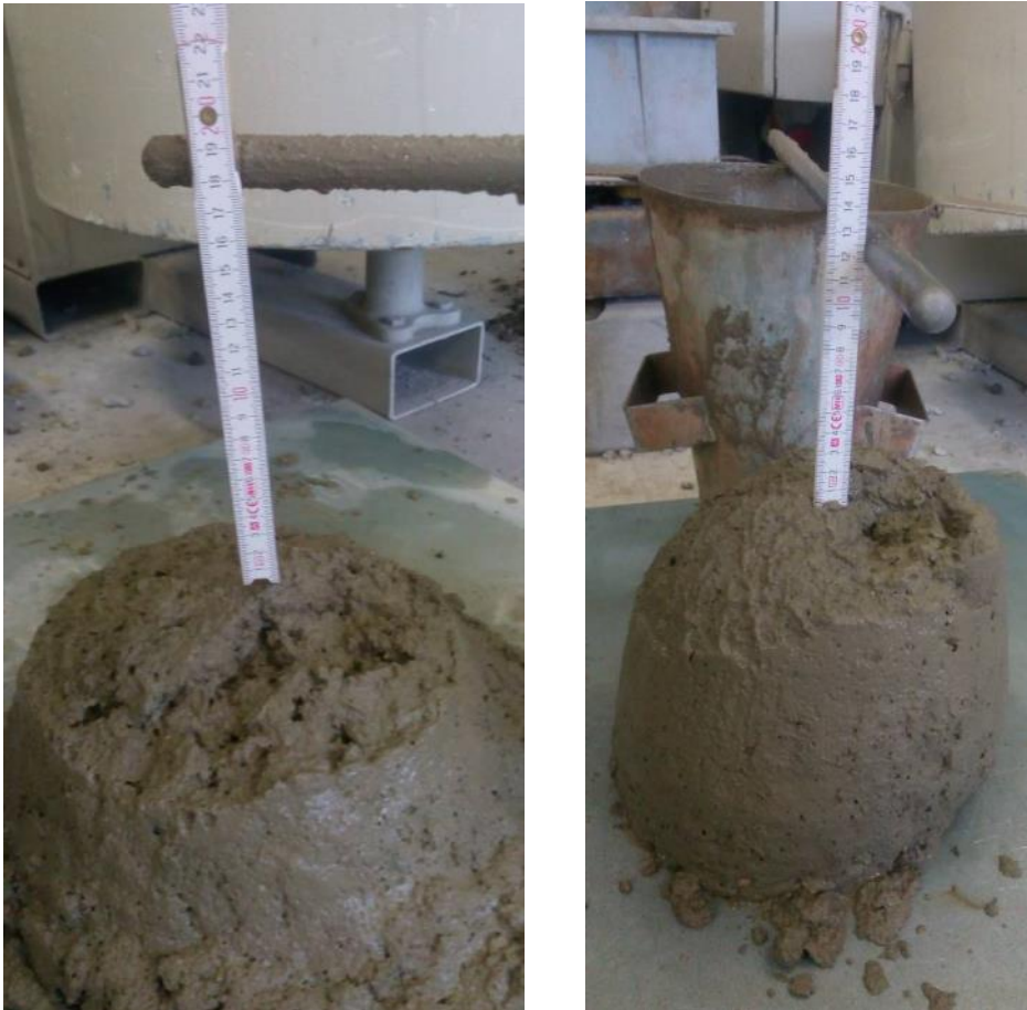
Obr. 39, 40: Sednutí CEM – vlevo 5 minut 170 mm, vpravo 60 minut 120 mm
