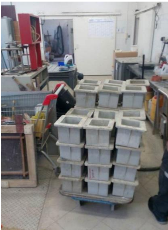
Obr. 14,15: Vlevo použité plastové formy, vpravo přístroj použitý pro zkoušky pevnosti v tlaku
