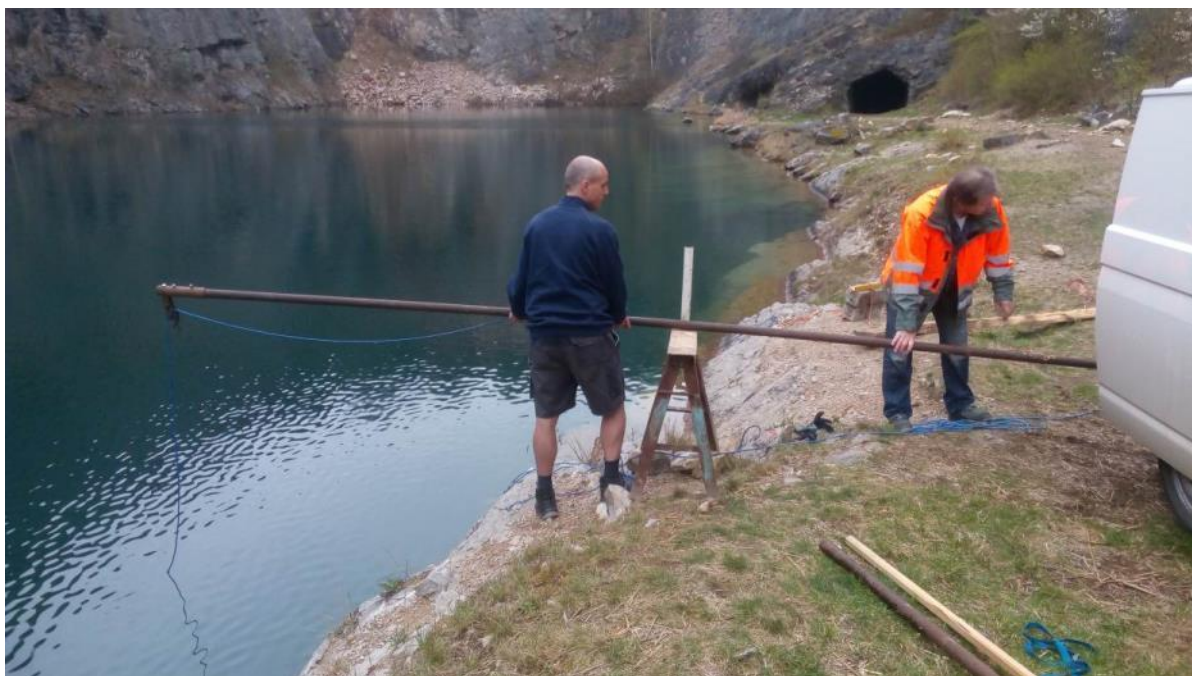
Obr. 28: Část konstrukce pro vytahování vzorků – ocelová koza, lešenářská trubka a přišroubovaná kladka
