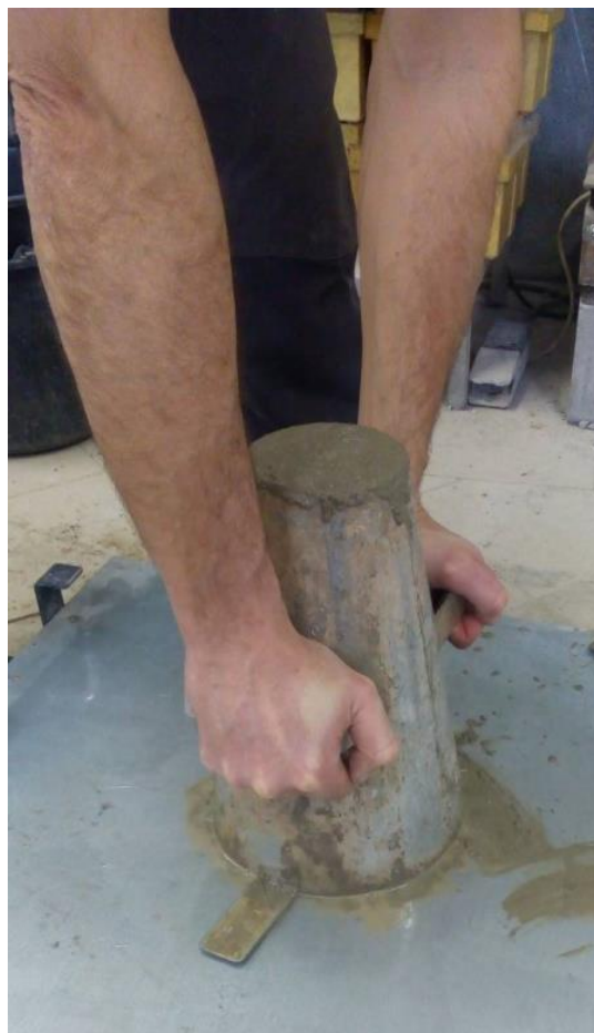
Obr. 33, 34: Vlevo hutnění betonu ukládaného do formy pro zkoušku sednutí kužele, vpravo plná forma před zvednutím
