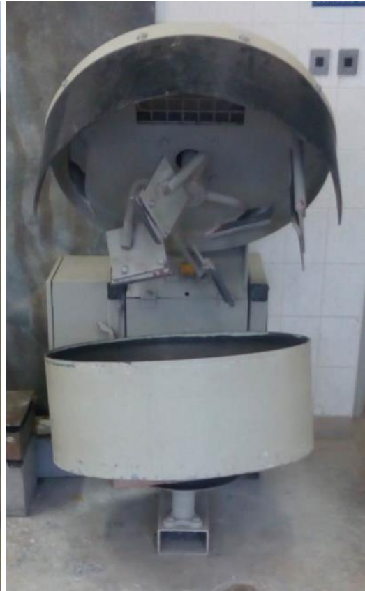
Obr. 12, 13: Vlevo je použitá váha, vpravo míchačka pro záměs 70 litrů betonu
