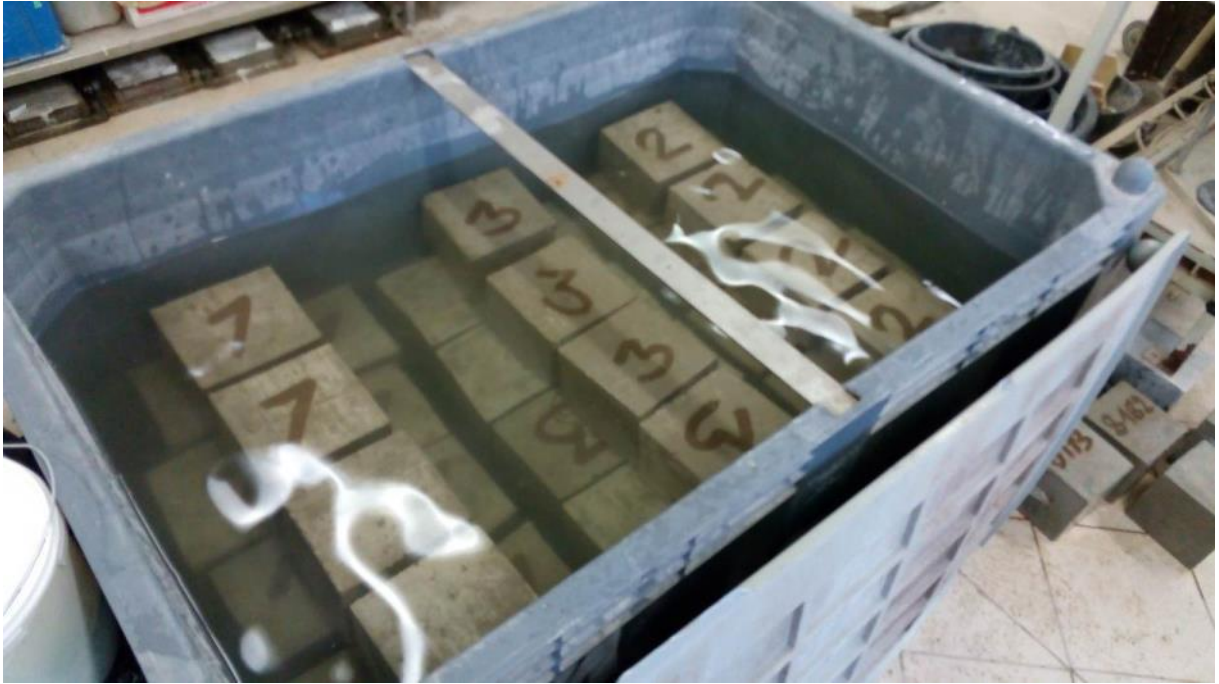
Obr. 22: Betonové krychle uložené ve vodní lázni
