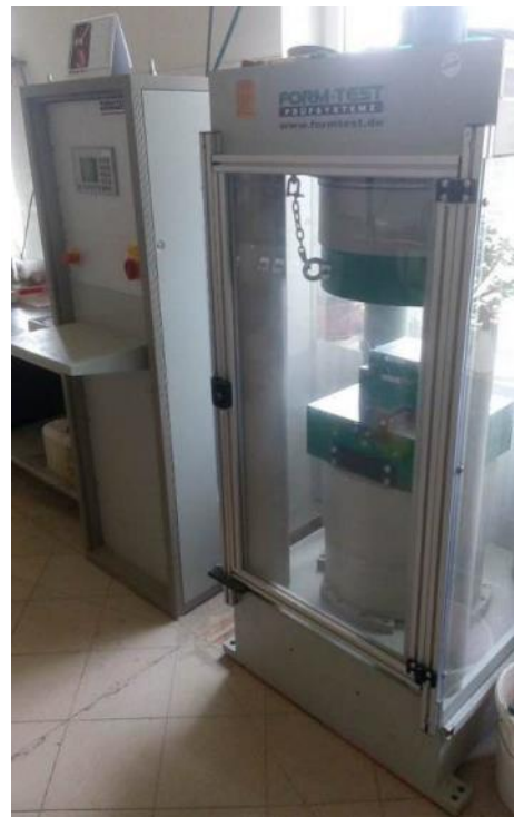
Obr. 14,15: Vlevo použité plastové formy, vpravo přístroj použitý pro zkoušky pevnosti v tlaku
