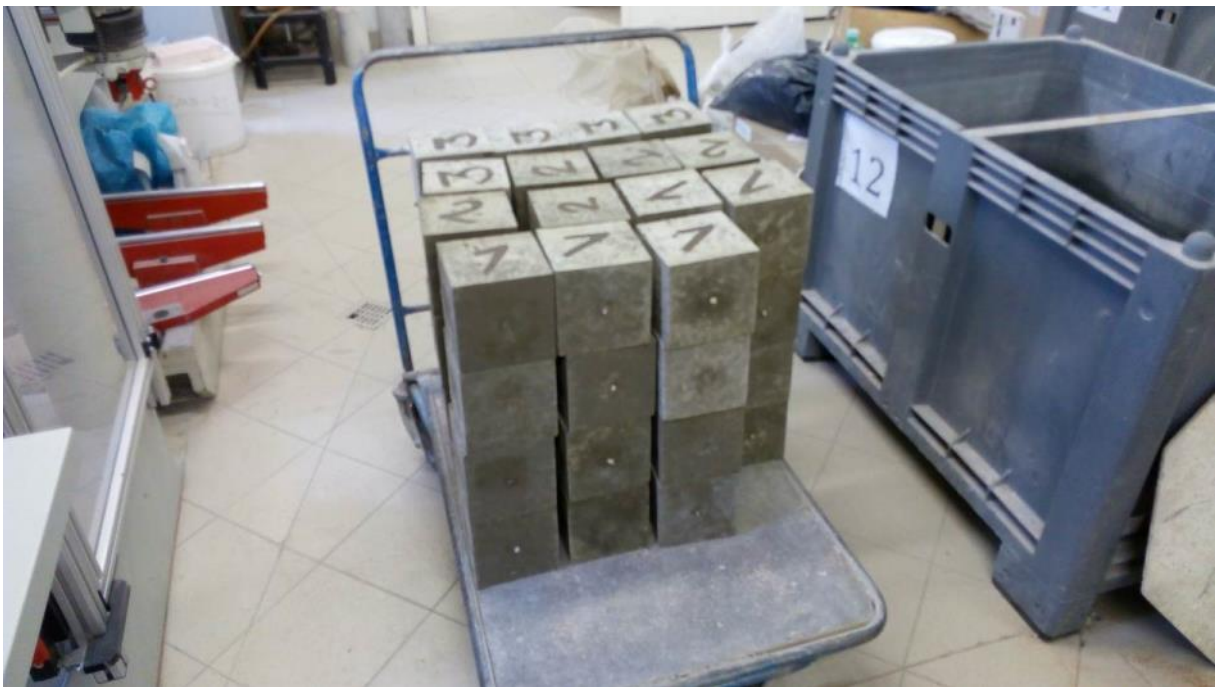
Obr. 21: Odformované betonové krychle připravené pro uložení do vodní lázně na 28 dní
