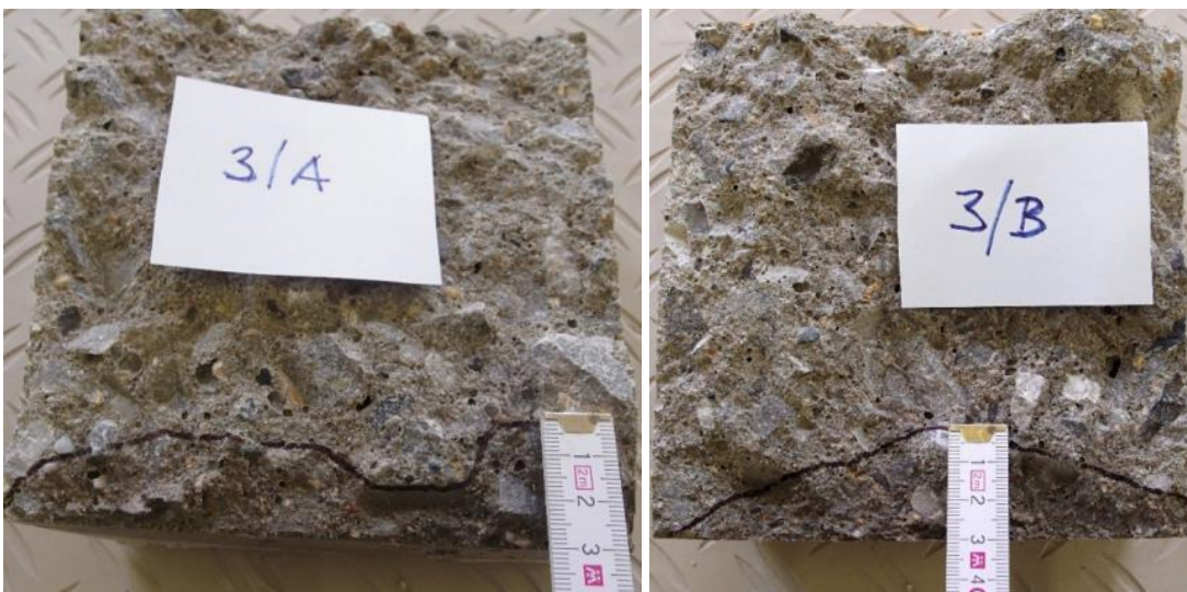
Obr. 67, 68: Průsaky tlakovou vodou dvou vzorků CEM D – vlevo 30 mm, vpravo 30 mm
