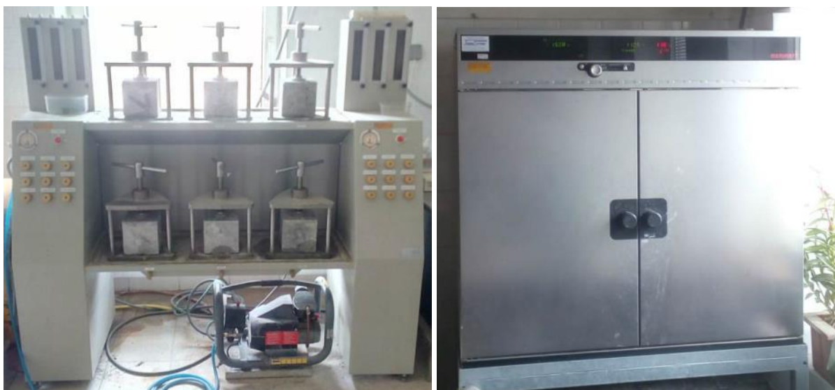
Obr. 10, 11: Vlevo zkušební stolice pro zatížení hydrostatickým tlakem, vpravo sušárna
