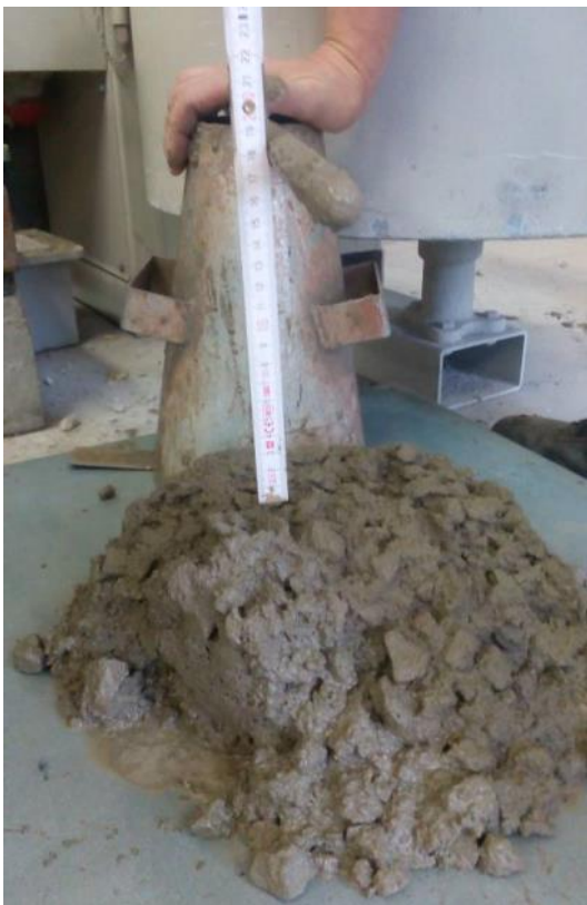
Obr. 37, 38: Sednutí XYP – vlevo 5 minut 180 mm, vpravo 60 minut 150 mm
