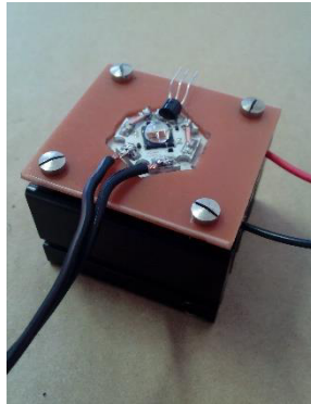
Obrázek 3.16: Zapojení chladič - Peltierův článek - luminiscenční dioda - teplotní čidlo
