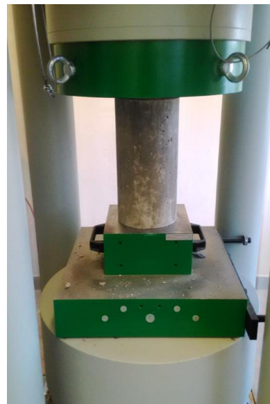
Obr. 3.08- Zkouška válcové pevnosti v tlaku
