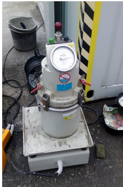
Obr. 2.02- Zkouška obsahu vzduchu
