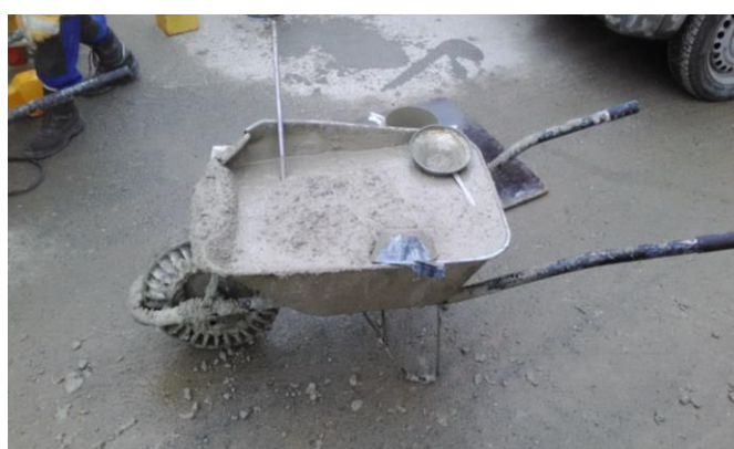
Obr. 3.02- Připravená betonová směš pro měření sednutí
