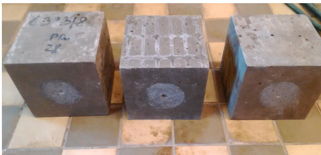
Obr. 2.06- Narušení vzorků před osazením na zkoušku: Hloubka průsaku tlakovou vodou
