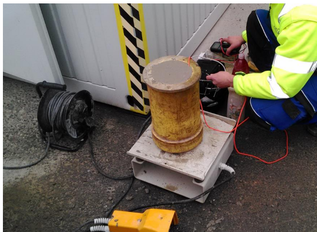
Obr. 3.34- Měření objemových změn betonu
