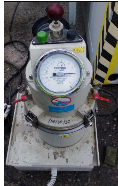
Obr. 2.03- Zkouška obsahu vzduchu
