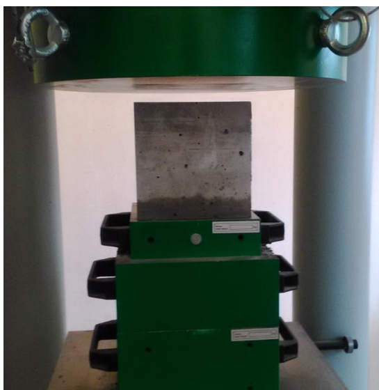
Obr. 3.07- Zkouška krychelné pevnosti v tlaku
