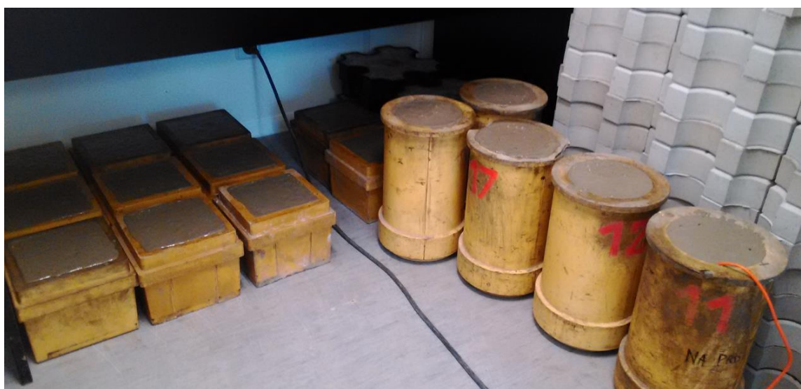
Obr. 3.03- Uskladnění části vzorků před odbedněním (1. etapa)
