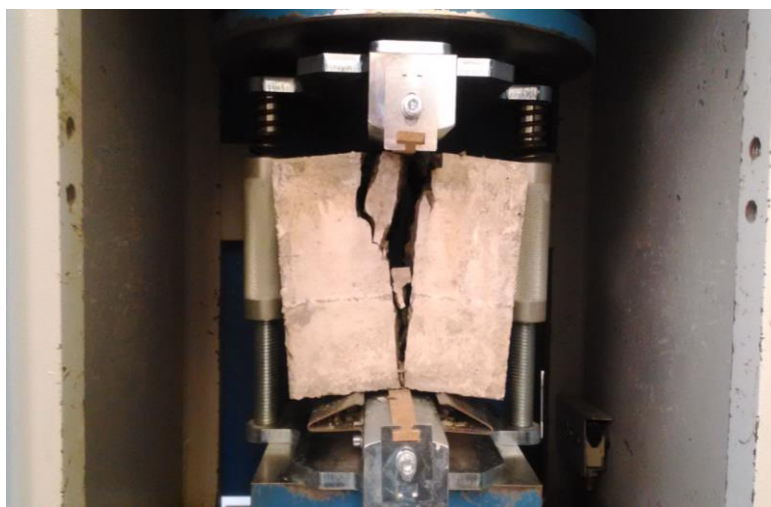
Obr. 3.09- Zkouška krychelné pevnosti v tlaku
