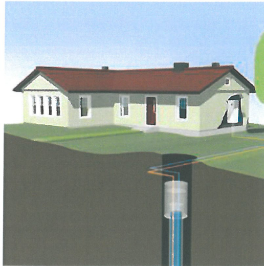
Obrázek č. 12: Schéma TČ země/voda se svislým vrtem [9]
