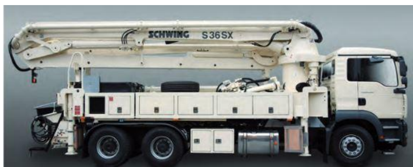
Obr. 20- Autočerpadlo SCHWING S 36 SX [7]
