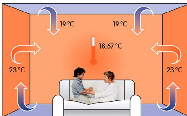
Obrázek 24: Rozložení teploty v místnosti – stěnové vytápění [33]
