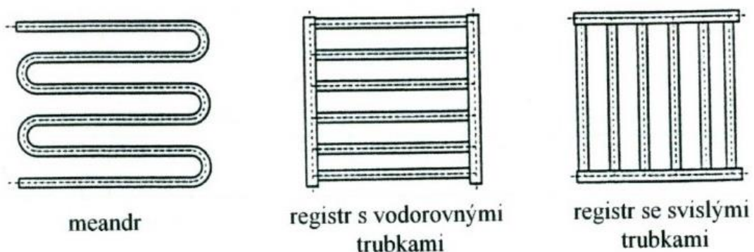
Obrázek 7: Uspořádání trubek u trubkového otopného tělesa [19]
