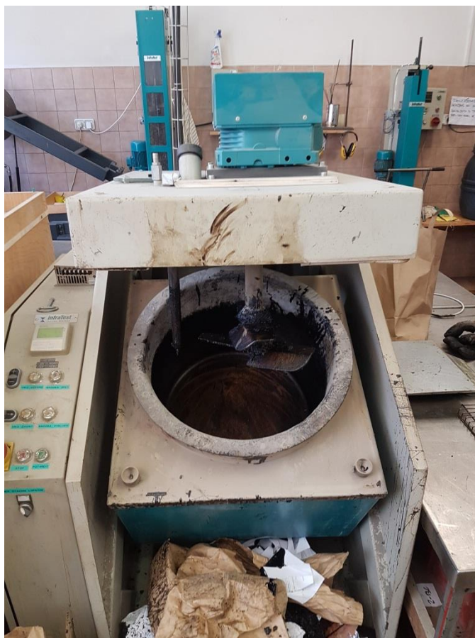
Obr. č. 11 Laboratorní míchačka [15]
