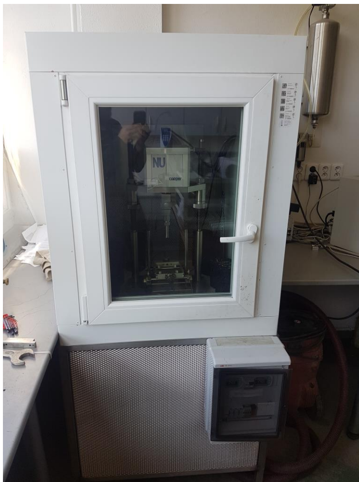
Obr. č. 27 Termostatická komora s nuceným oběhem vzduchu, ve které je umístěno zkušební zařízení
