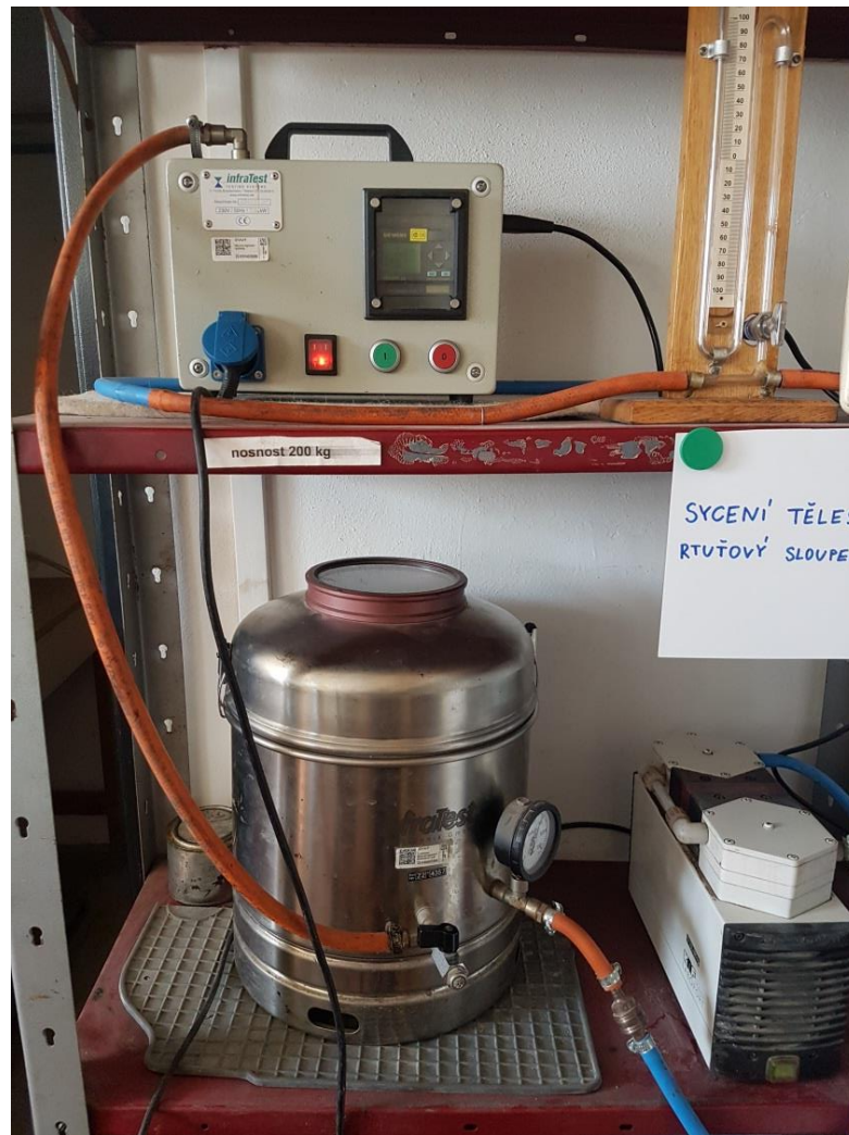
Obr. č. 20 Vývěva s manometrem [15]
