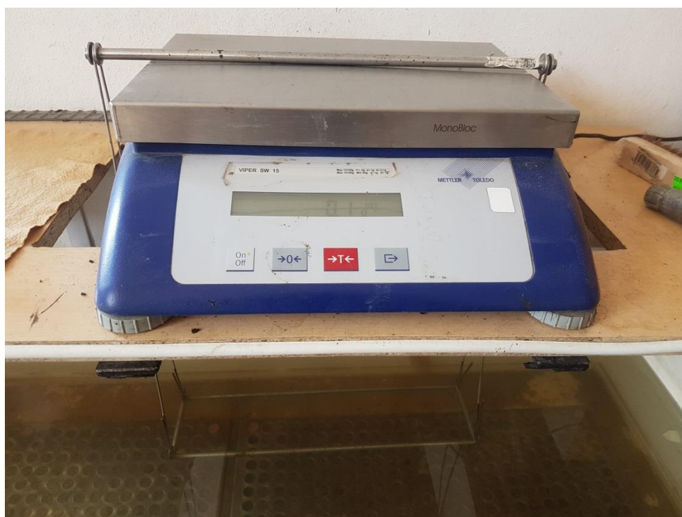
Obr. č. 21 Laboratorní váhy uzpůsobené k vážení ponořených těles [15]
