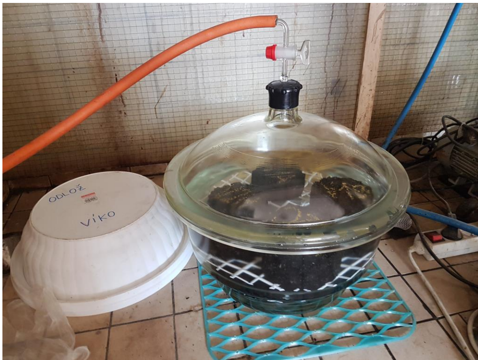
Obr. č. 25 Tělesa ve vakuové komoře při absolutním tlaku 6,7 \pm 0,3 kPa [15]
