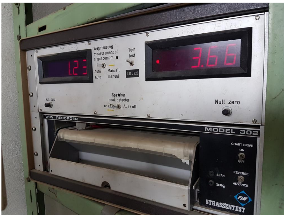
Obr. č. 23 Měřicí zařízení zapojené k laboratornímu lisu [15]
