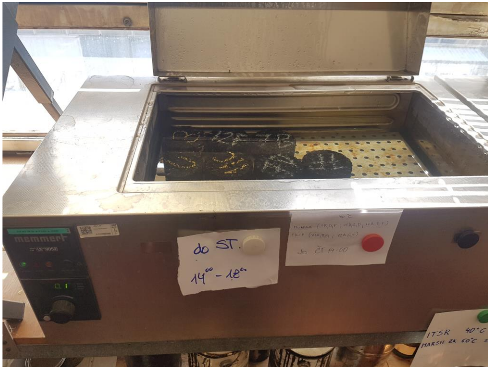
Obr. č. 24 Vodní lázeň s termostatickou regulací [15]
