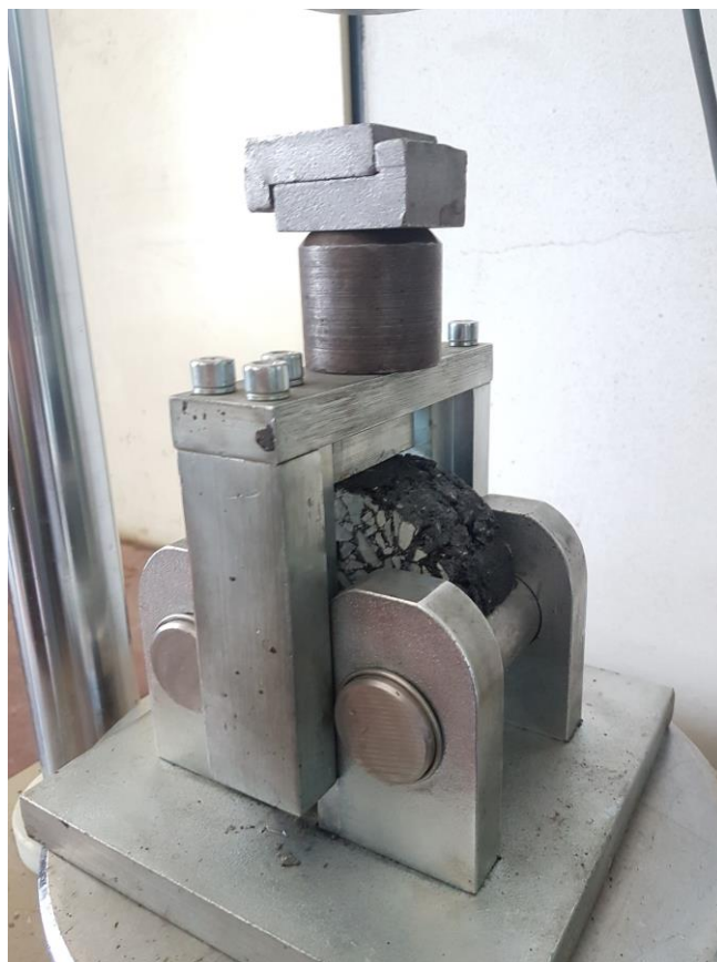
Obr. č. 30 Zkušební rám pro tělesa o průměru 100 \pm 3 mm s vloženým tělesem [15]
