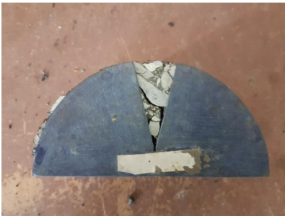
Obr. č. 31 Použití destičky s výsečí pro kontrolu umístění trhliny [15]
