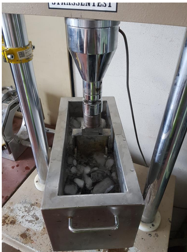
Obr. č. 33 Průběh zkoušky relaxace zkušebního tělesa v izolované vodní lázni s drceným ledem [15]
