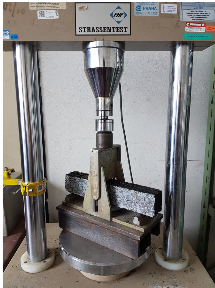
Obr. č. 32 Zkušební hranol upevněný a připravený ke zkoušce v tahu za ohybu [15]
