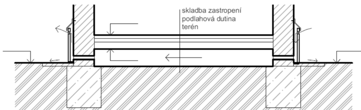
Obr. 10 Vzduchová dutina vytvořená zastropením (kombinace se soklovou dutinou)
