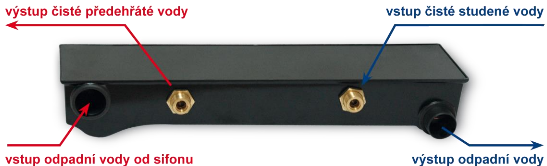
Obr. 5 – AS SPRCHA pro lokální rekuperaci tepla z šedé vody
