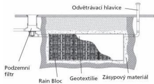
↑Obr.16 – Schéma konstrukčního řešení uložení vsakovacích boxů
